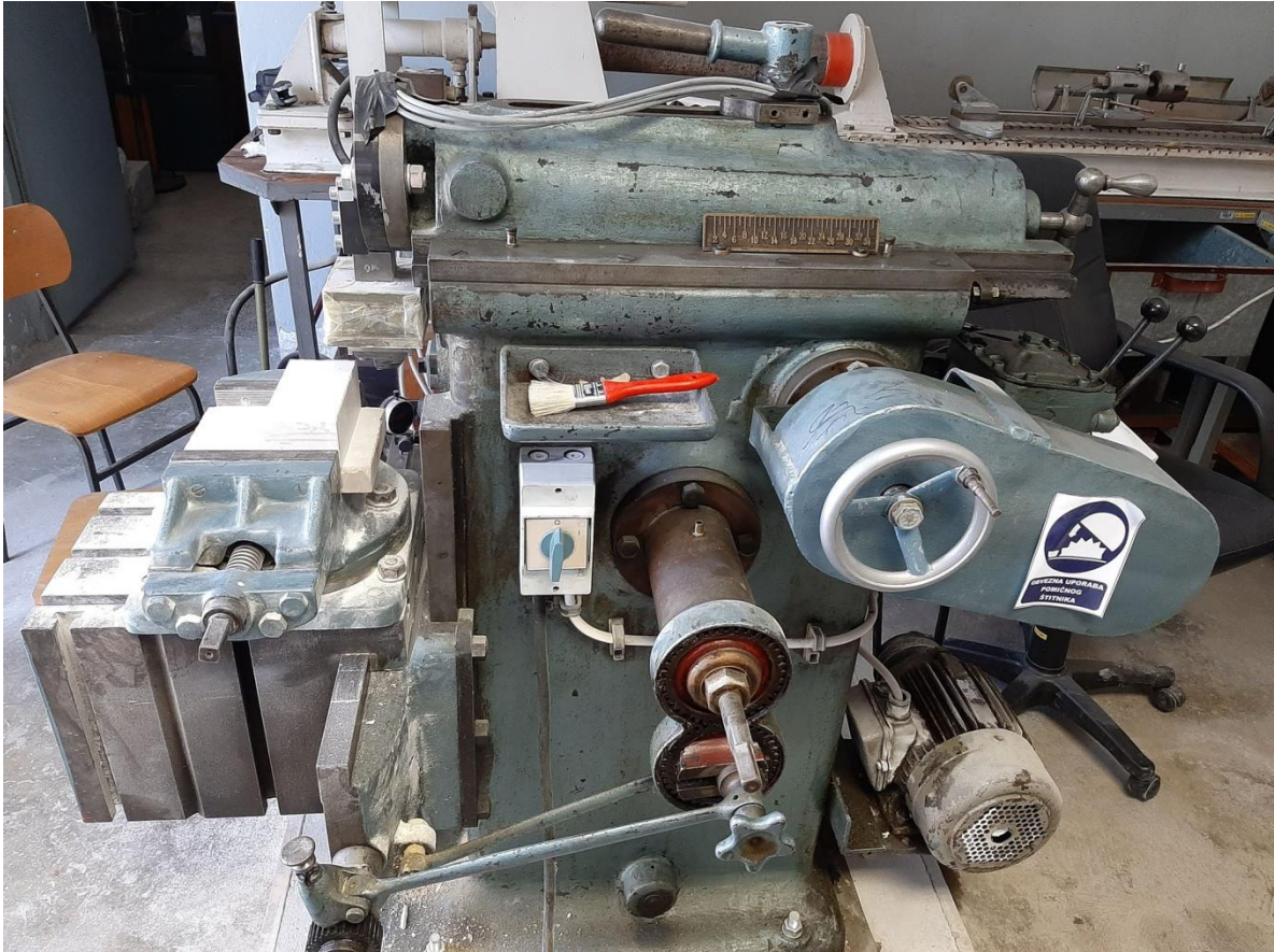
Slika 4-2 Uređaj za pravolinijsko rezanje stijena s mjernim pretvornikom
