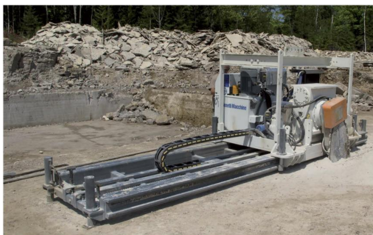
Slika 2-1 Lančana sjekačica na tračnicama (Dunda i Kujundžić, 2003).
