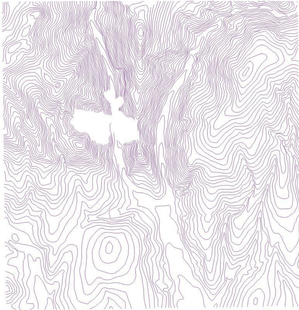
Slika Error! No text of specified style in document.-4 Prikaz vektoriziranih slojnica
