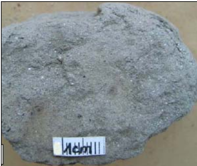
Slika 3.25: Uzorak litoarenita u vršnom dijelu ležišta TUV u bušotini Klo-57 (788,9 – 793,3 m, III. m) (autor TADEJ, J., iz studije: VELIĆ et al., 2008*)
