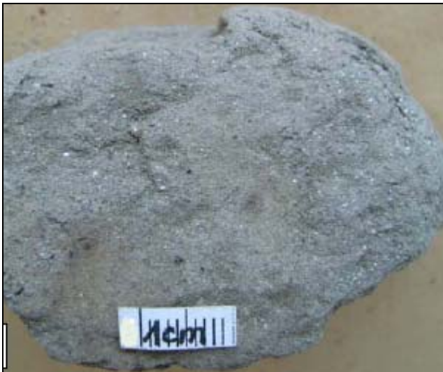
Slika 3.25: Uzorak litoarenita u vršnom dijelu ležišta TUV u bušotini Klo-57 (788,9 – 793,3 m, III. m) (autor TADEJ, J., iz studije: VELIĆ et al., 2008*)
