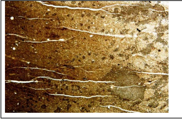
Slika 3.30: Lapor s otvorenom mikrofrakturnom poroznošću, (Klo – 12, 1071,0 – 1073,0 m, I. m) (autor TADEJ, J., iz studije: VELIĆ et al., 2008*)
