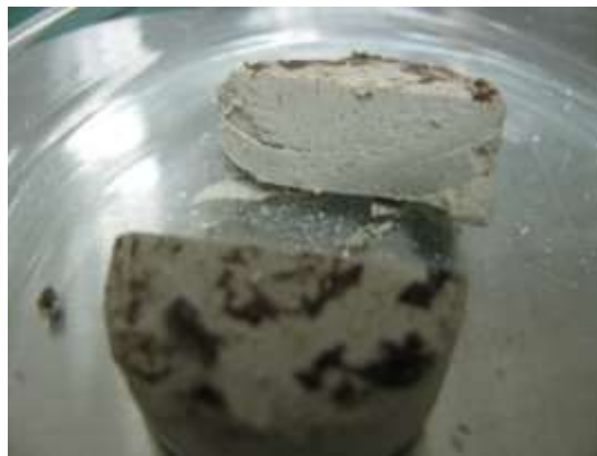
Slika 3-76. Izgled poprečnog presjeka peleta 0Q20M80K nakon bubrenja u gipsnoj isplaci G2PAC
