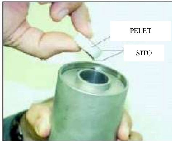
Slika 3-9. Umetanje peleta i sita u ispitnu ćeliju
