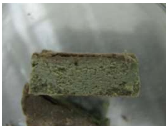
Slika 3-80. Izgled poprečnog presjeka peleta 10Q80M10K nakon bubrenja u kalijskoj isplaci K4PAC
