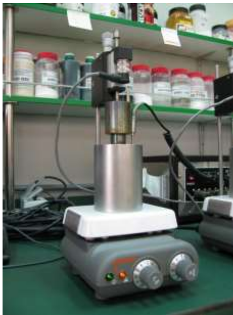
Slika 3-8. Jedinica za mjerenje bubrenja peleta
