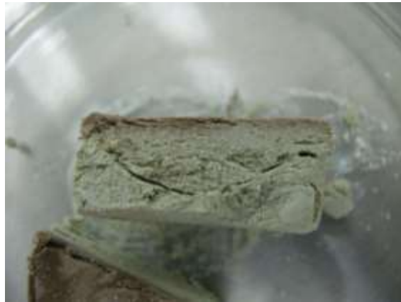
Slika 3-69. Izgled poprečnog presjeka peleta 0Q60M40K nakon bubrenja u kalijskoj isplaci K2PAC
