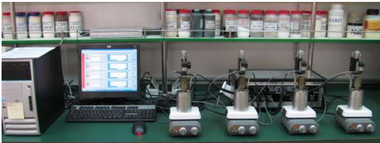
Slika 3-7. Uređaj za mjerenje bubrenja peleta
