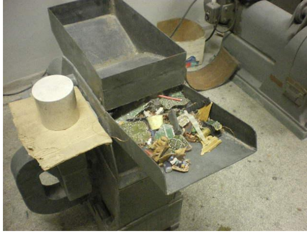
Slika 4 - 184 Sekundarno sitnjenje tiskanih pločica u udarnoj drobilici sa rotirajućim pločicama
