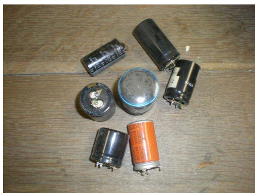
Slika 4 – 241 Elektrolitski kondenzatori \varnothing + 25 mm i visine + 25 mm
