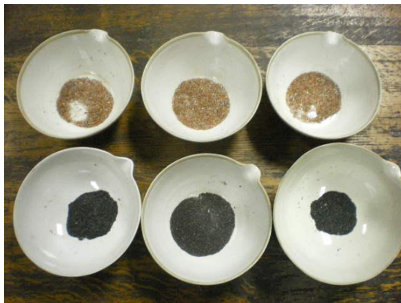
Slika 4 – 179 Prikaz tri uzorka klase 1/0,5 mm nakon magnetske separacije – u gornjim posudama nalazi se nemagnetična (nekorisna) komponenta, a u donjim posudama magnetična (korisna) komponenta
