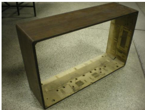
Slika 4 – 239 Drveno kućište nakon demontaže
