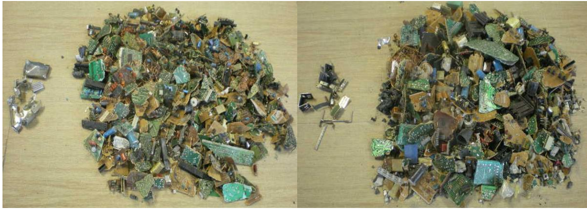
Slika 4 – 182 Ručnim probiranjem izdvojeni limovi i pojedini veći komadi metala koji se izdvajaju iz daljnjih postupaka sitnjenja
