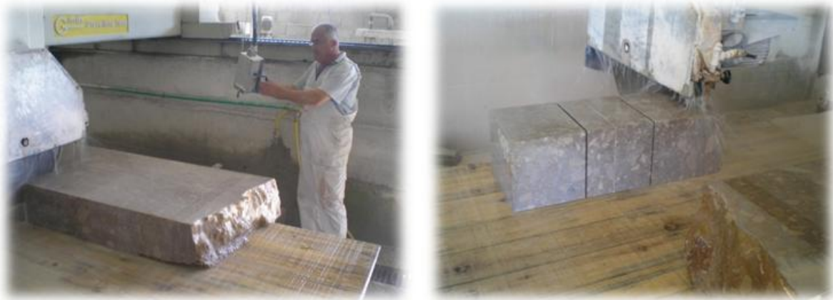
Slika 6.6. Tehnološka proba rezanja na disk pili
