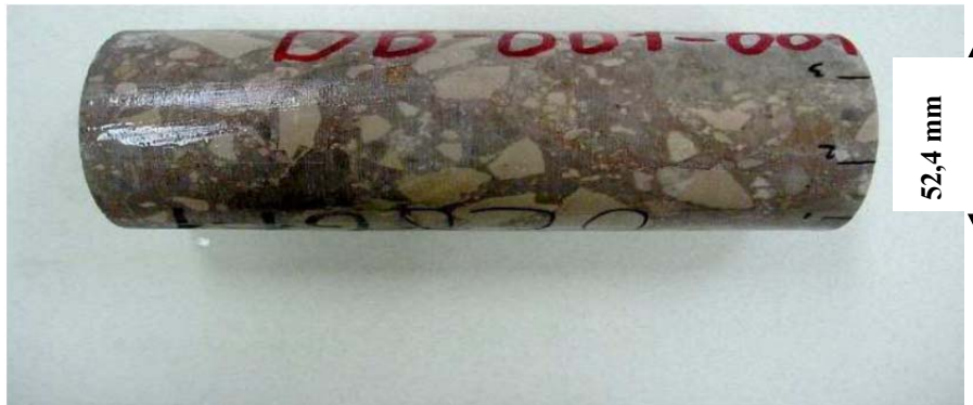
Slika 7.3. Uzorak oznake DB-001-001 pripremljen za ispitivanja fizičko-mehaničkih svojstava
