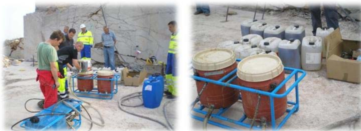
Slika 7.21. Oprema i materijal potrebni za izvođenje probe utiskivanja
