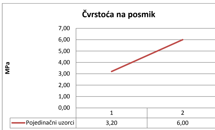
Slika 7.46. Prikaz ispitivanja čvrstoće na posmik zalijepljene stijene
