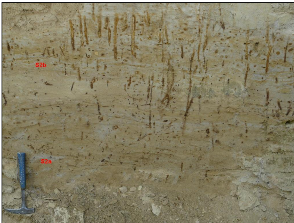
Slika 34 Profil Suza-2. U lesolikom sedimentu vidljivi su limonitizirani ostaci slatkovodne flore u 'in-situ' položaju. Oznakama S2a i S2b označena su mjesta uzorkovanja. Geološki čekić je mjerilo.
