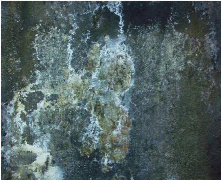
Slika 4-10. Naslage koje upućuju na prisutnost sulfida i klorida na površini uzorka naftovoda
