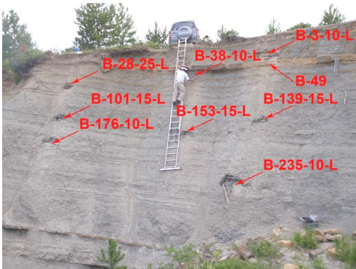
Slika 86 - Prikaz mjesta na kojima su uzeti uzorci za PLT analizu te mjesta na kojima je izvršeno testiranje Schmidtovim čekićem na ogolini Boljun
