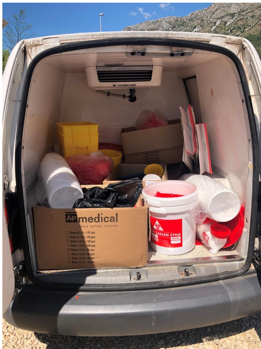
Slika 3-5. Unutrašnjost kombija s ugrađenim sustavom za hlađenje
