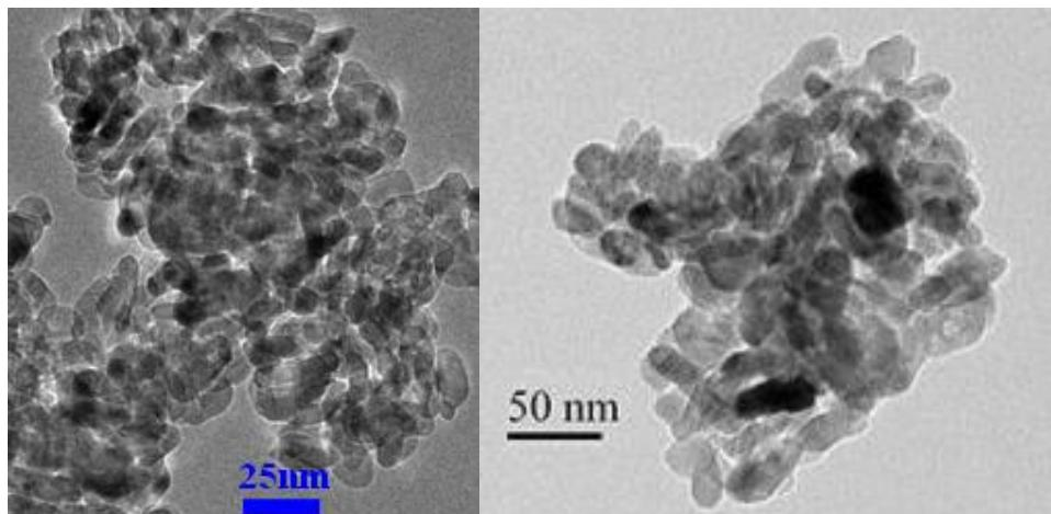
**Slika 4-4.** TEM snimke nanočestica TiO<sub>2</sub> prosječne veličine 18 nm (lijevo) i prosječne veličine 30 do 50 nm suspendiranih u vodi u koncentraciji 40 % mas. (desno) ([www.us-nano.com/inc/sdetail/269](http://www.us-nano.com/inc/sdetail/269) i [www.us-nano.com/inc/sdetail/2610](http://www.us-nano.com/inc/sdetail/2610))
