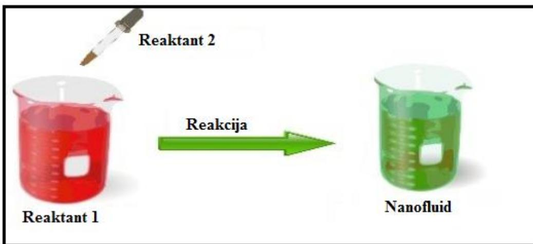
Slika 1-4. Jednostupanjski postupak pripreme nanofluida (Mukherjee i Paria, 2013)
