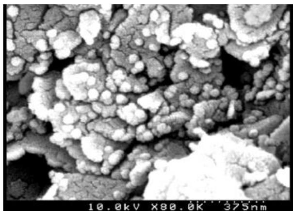
**Slika 1-7.** SEM snimka nanočestica  $\text{SiO}_2$  unutar Atoka šejla (Sensoy et al., 2009)
