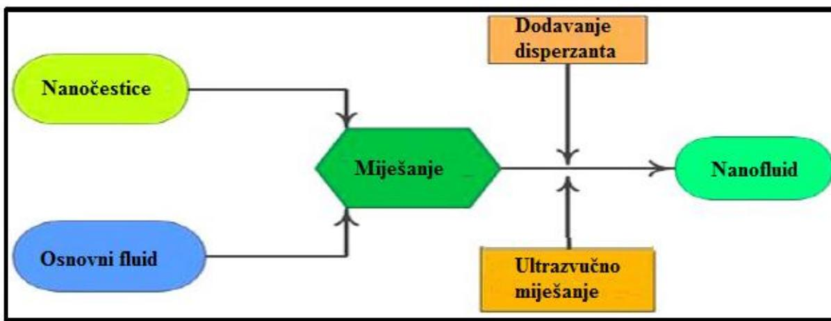
**Slika 1-5.** Dvostupanjski postupak pripreme nanofluida (Mukherjee i Paria, 2013)
