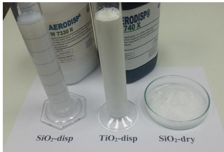
**Slika 4-1.** Nanočestice SiO<sub>2</sub> i TiO<sub>2</sub> suspendirane u vodi i nanočestice SiO<sub>2</sub> u obliku praha
