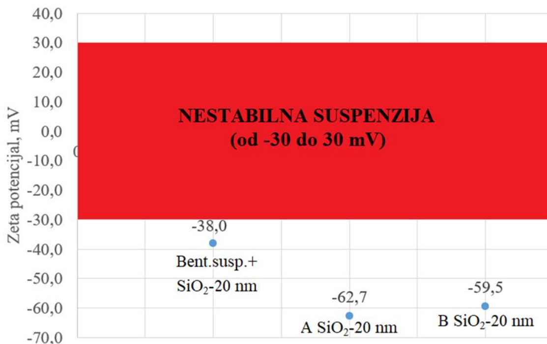
Slika 8-1. Izmjerene vrijednosti zeta-potencijala za isplake koje sadrže nanočestice SiO 2 veličine 20 nm
