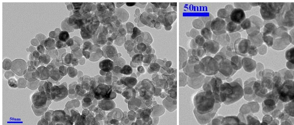
**Slika 4-6.** TEM snimke nanočestica  $\text{Fe}_2\text{O}_3$  prosječne veličine 30 nm (lijevo) i prosječne veličine 20 nm dispergiranih u vodi u koncentraciji 10 % mas. (desno) ([www.us-nano.com/inc/sdetail/594](http://www.us-nano.com/inc/sdetail/594) i [www.us-nano.com/inc/sdetail/20719](http://www.us-nano.com/inc/sdetail/20719))
