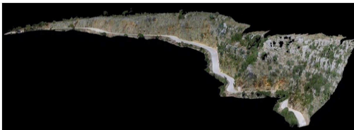
Slika 4.3. Model oblaka točaka istraživanih stijenskih kosina Brljan vizualiziran u računalnom programu CloudCompare .
