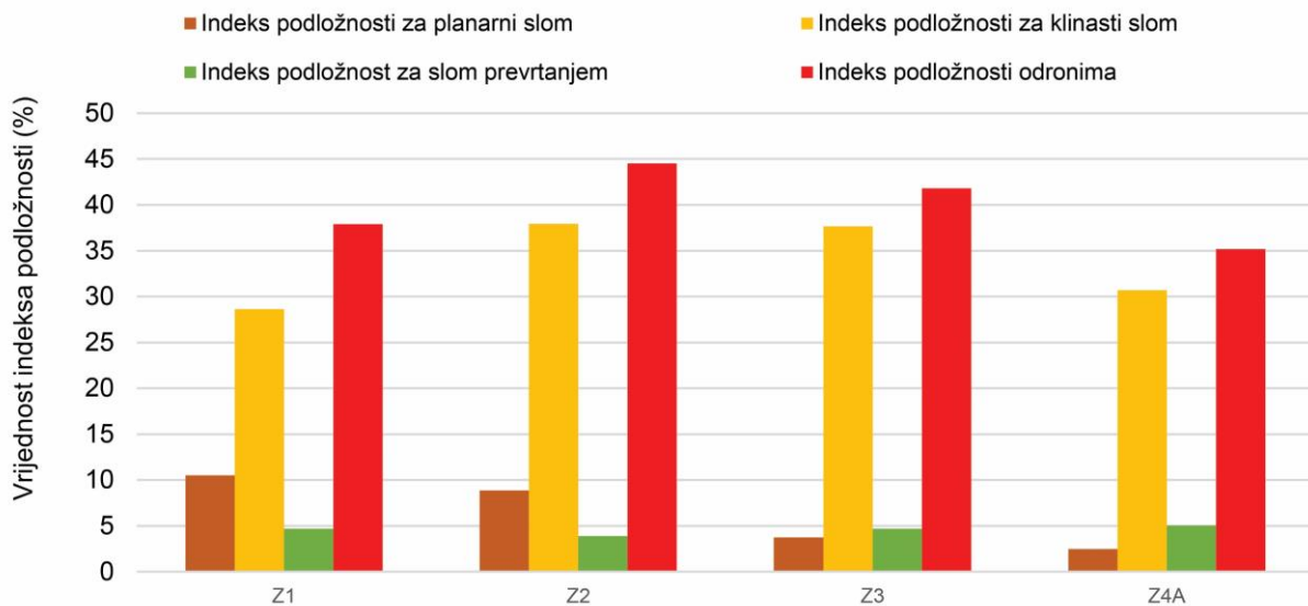
Slika 6.18. Prikaz prosječnih vrijednosti indeksa podložnosti za svaku vrstu sloma te indeksa podložnosti odronima za sve inženjerskogeološke zone na pilot području stijenskog zasjeka na lokaciji Špičunak.
