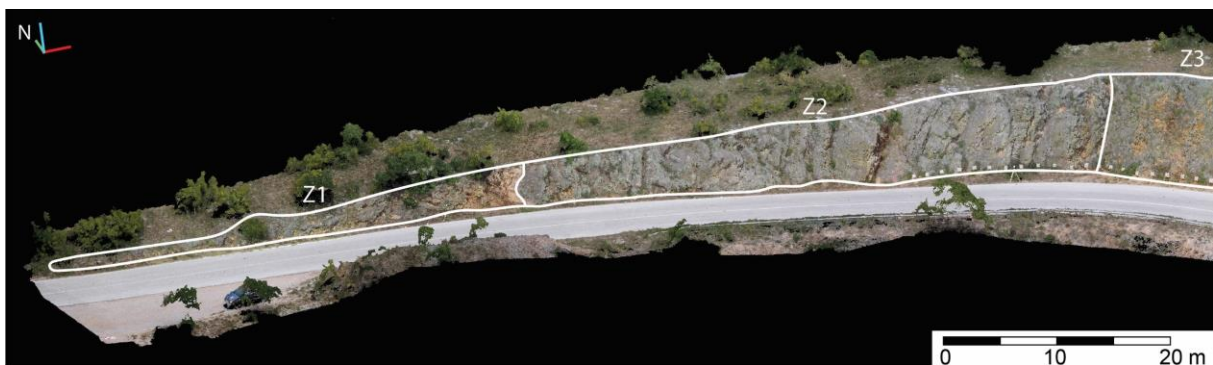
Slika 5.37. Pogled prema sjeveru na inženjerskogeološke zone Z1 i Z2 s ucrtanim granicama na visokorezolucijskom digitalnom modelu istraživanih stijenskih kosina.
