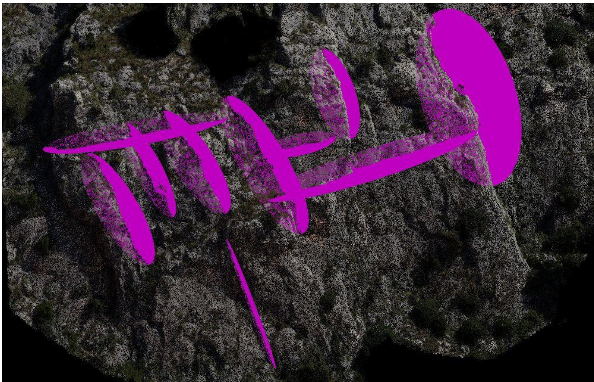
Slika 4.17. Prikaz primjera ručno postavljenih najbolje odgovarajućih ploha koje predstavljaju diskontinuitete (označeno ljubičastom bojom) na temelju iscrtanih tragova ravnina u Split FX -u.
