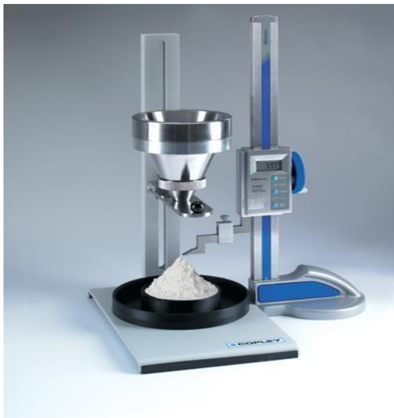
Slika 3.5 Aparatura za metodu promjenjive visine lijevka (AraChem, 2018)
