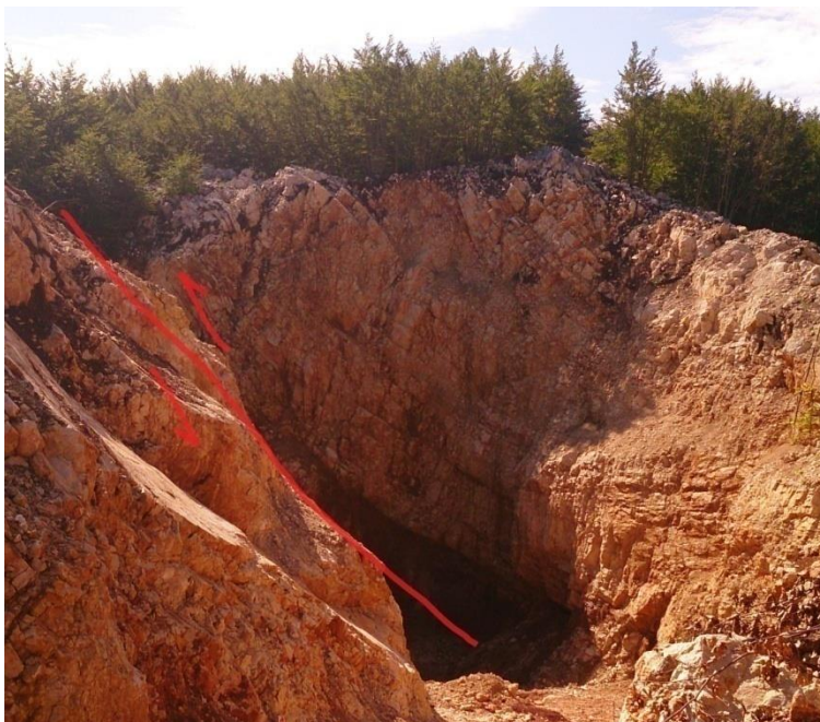
Slika 5-14. Reverzni rasjed unutar ležišta L-350.
