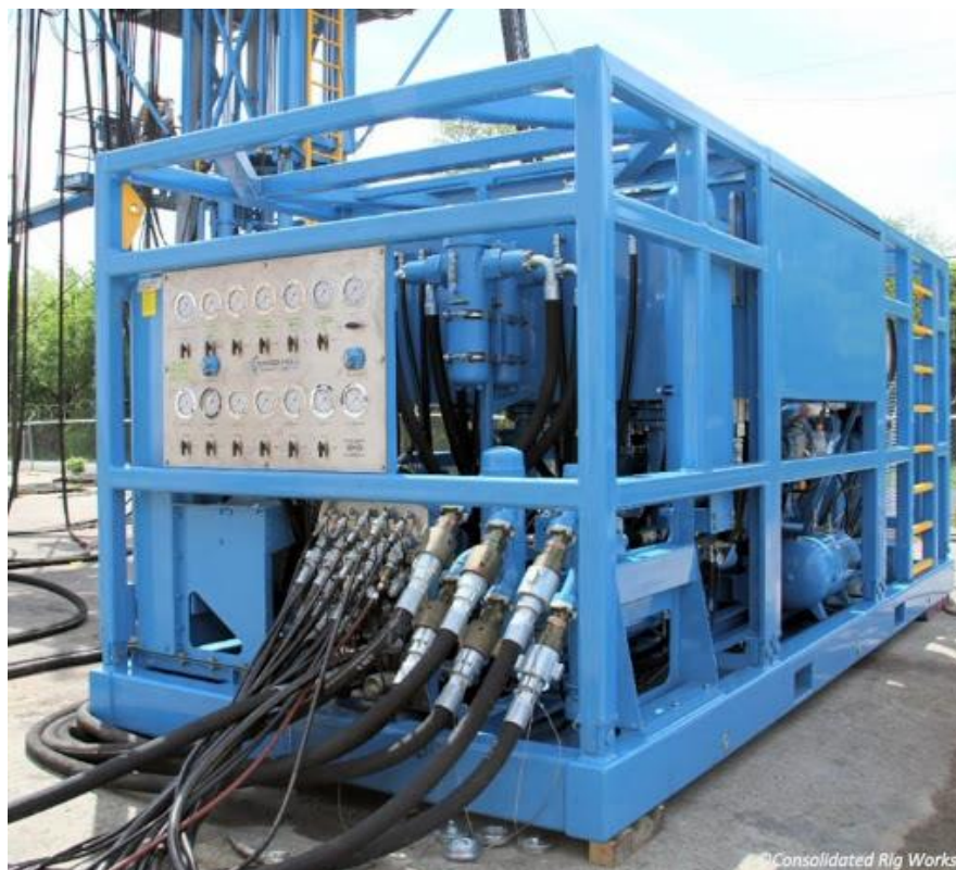
Slika 3-3. Pogonsko-hidraulički sustav savitljivog tubinga (Consolidate rig works, 2020)
