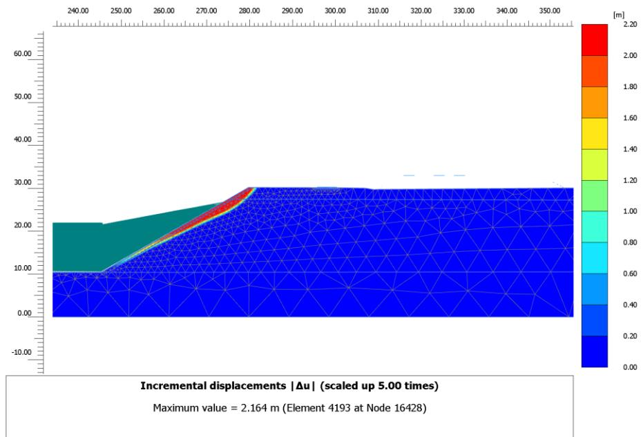
Slika 4-39 Inkrementalni pomaci SF 1 (kut unutarnjeg trenja šljunka  $37^\circ$ )
