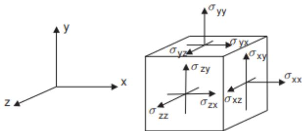
Slika 2-4 Generalni prikaz trodimenzionalnog sustava naprezanja (PLAXIS, 2016)
