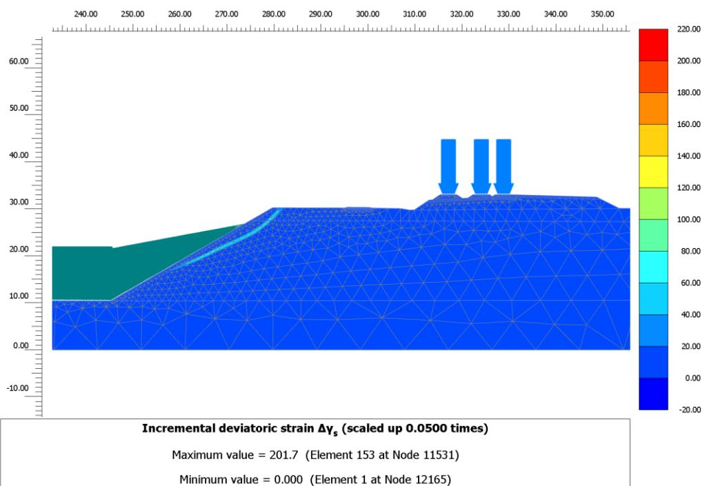
Slika 4–44 Inkrementalna smična naprezanja SF 3 (kut unutarnjeg trenja šljunka  $37^\circ$ )
