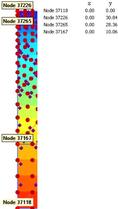
Slika 4-37 Detalj korišten za izračun efektivnih vertikalnih naprezanja
