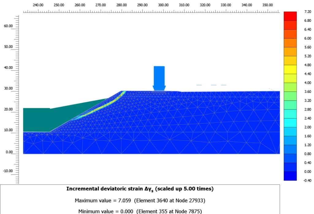
Slika 4–43 Inkrementalna smična naprezanja SF 2 (kut unutarnjeg trenja šljunka  $37^\circ$ )
