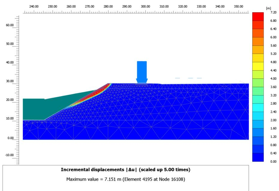
Slika 4-40 Inkrementalni pomaci SF 2 (kut unutarnjeg trenja šljunka  $37^\circ$ )
