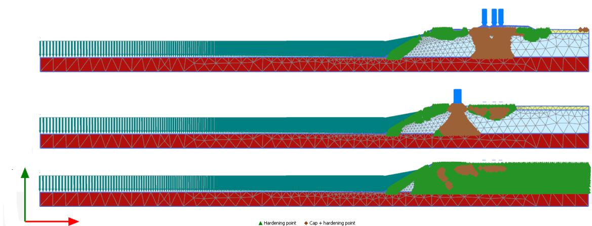
Slika 4-47 Zone ojačanog tla plastičnih analiza (kut unutarnjeg trenja šljunka  $37^\circ$ )
