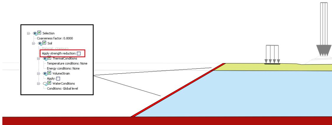
Slika 4-34 Izuzeti površinski slojevi kosine proračuna stabilnosti
