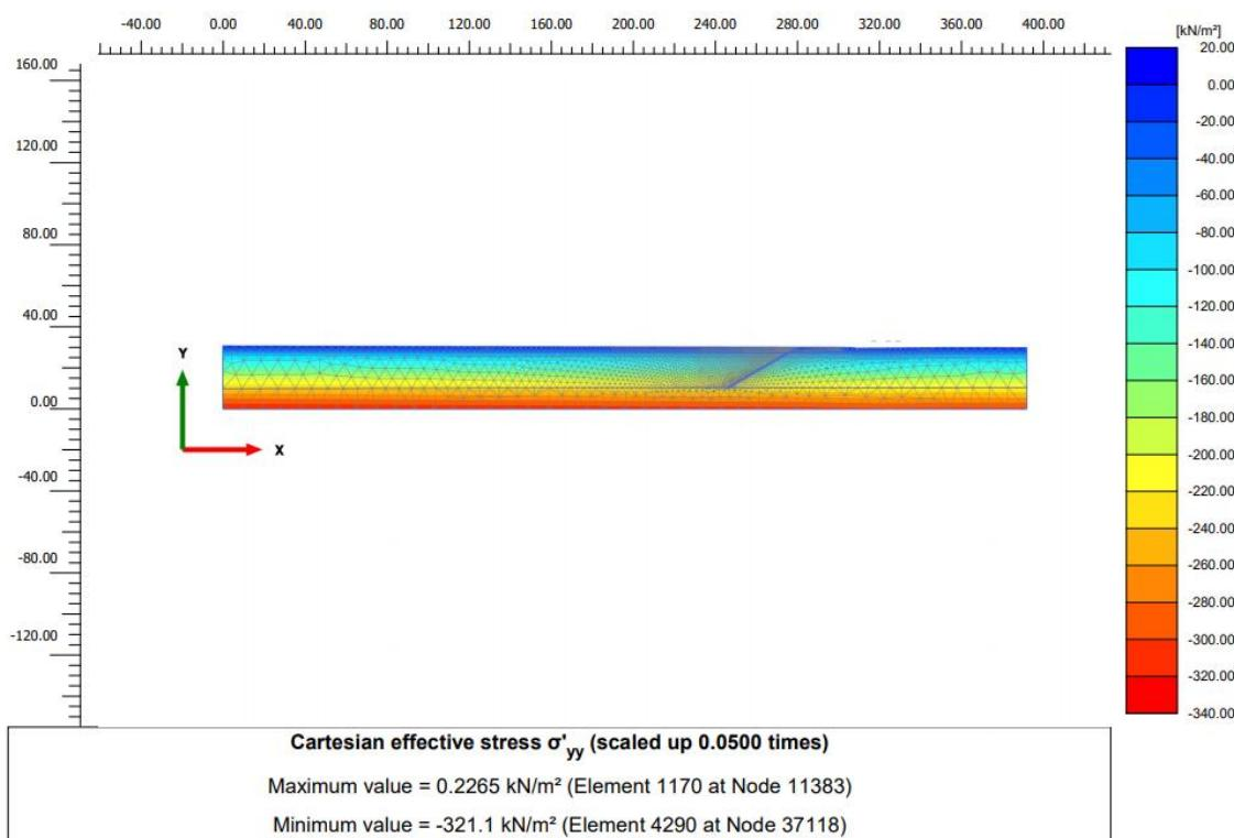
Slika 4-36 Ukupna efektivna vertikalna naprezanja početne faze (kut unutarnjeg trenja šljunka  $37^\circ$ )
