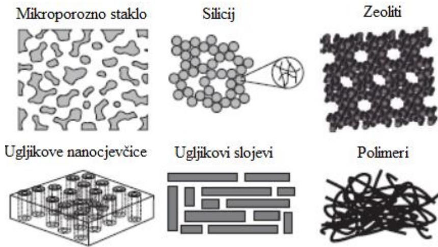
**Slika 2-10.** Strukture pora kod pojedinih vrsta membrana (Rajić, 2011)
