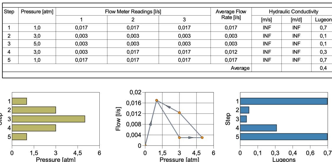
Slika 6.5. Dijagrami tlak-korak, tlak-protok i Lugeonova jedinica-korak za test broj 7
