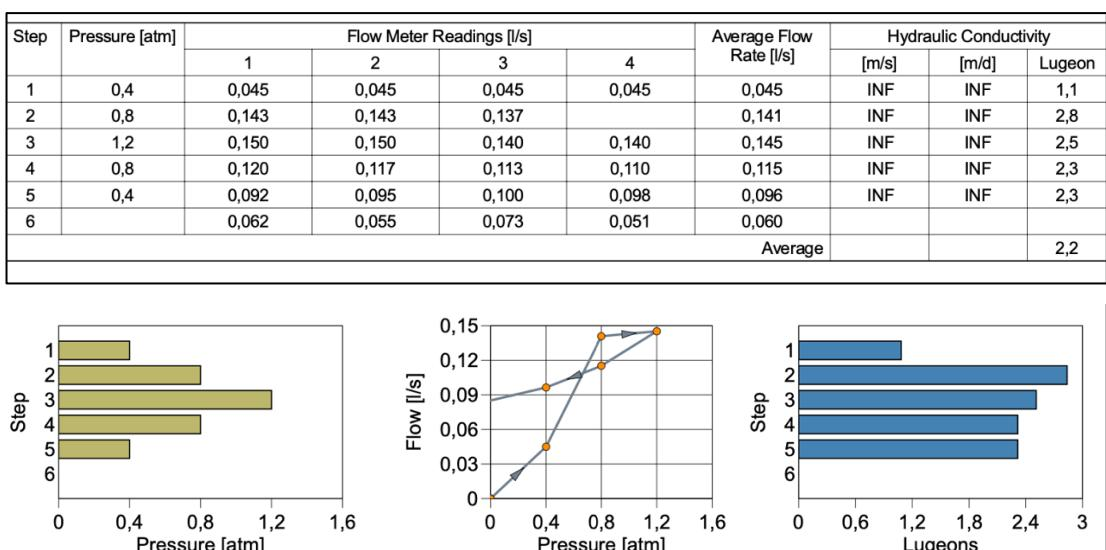
Slika 6.13 Dijagrami tlak-korak, tlak-protok i Lugeonova jedinica-korak za test broj 54
