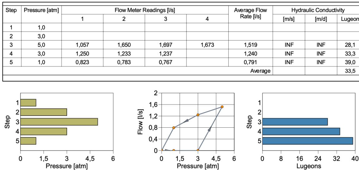
Slika 6.8. Dijagrami tlak-korak, tlak-protok i Lugeonova jedinica-korak za test broj 19
