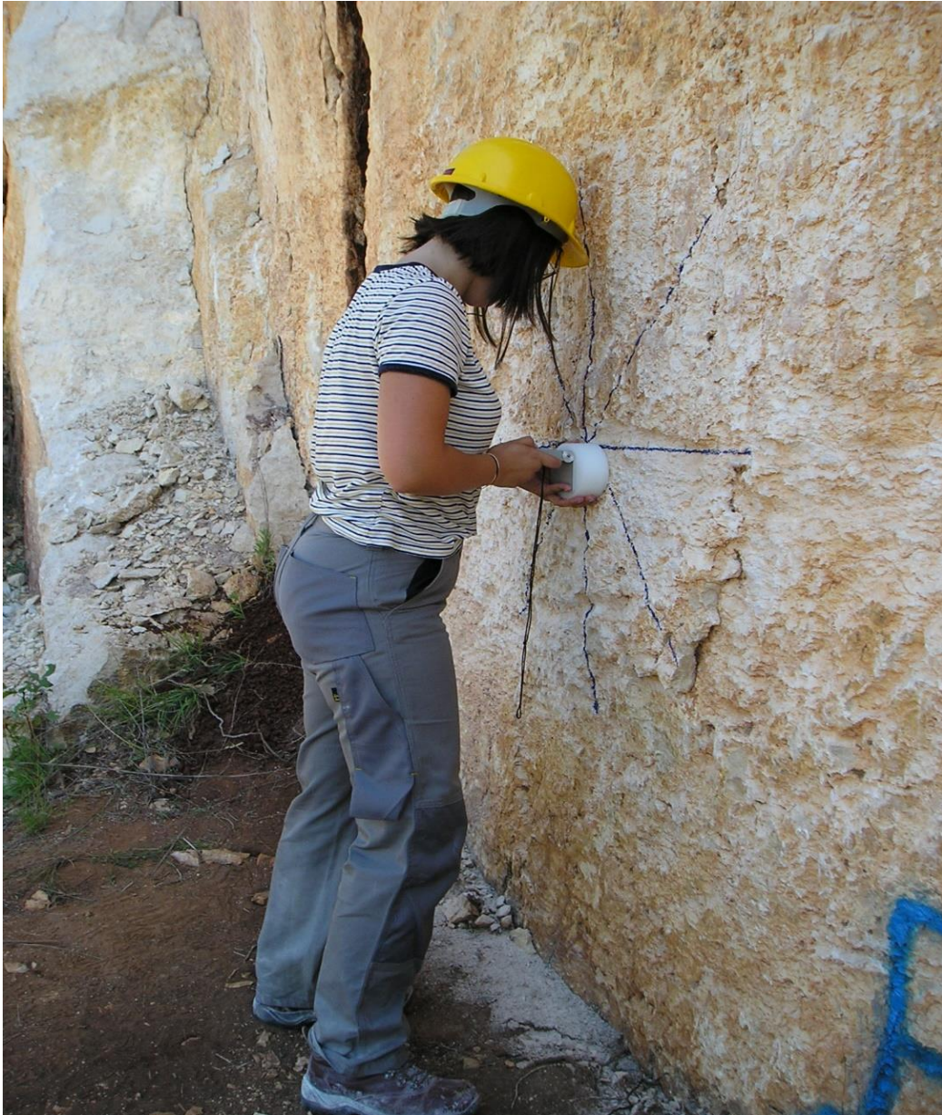
Slika 5-3 Primjer mjerenja orijentacije pomoću kružne ploče.
