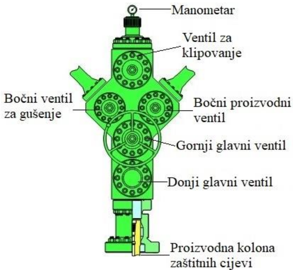
Slika 2-3. Monolitni erupcijski uređaj (pet-oil.blogspot.com, 2020)
