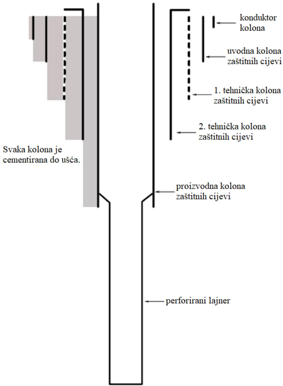
**Slika 3-1.** Tipična konstrukcija geotermalnih bušotina (Petrica, 2016)
