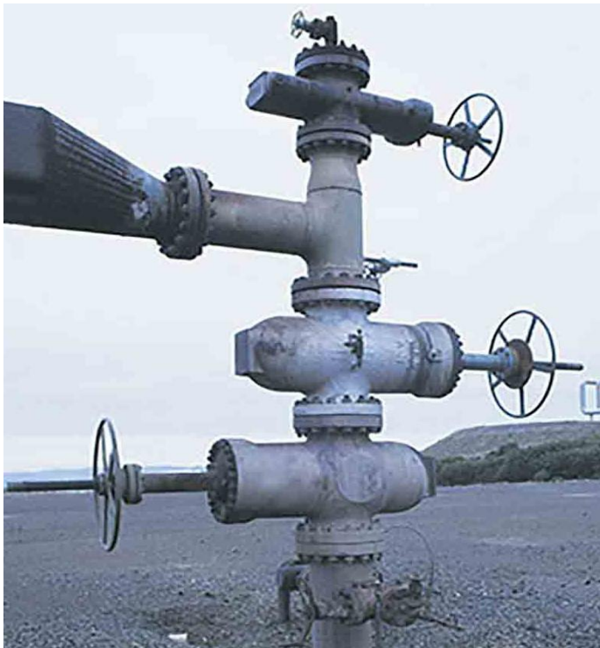
Slika 3-5. Bušotinska glava geotermalne bušotine (www.slb.com, 2020)
