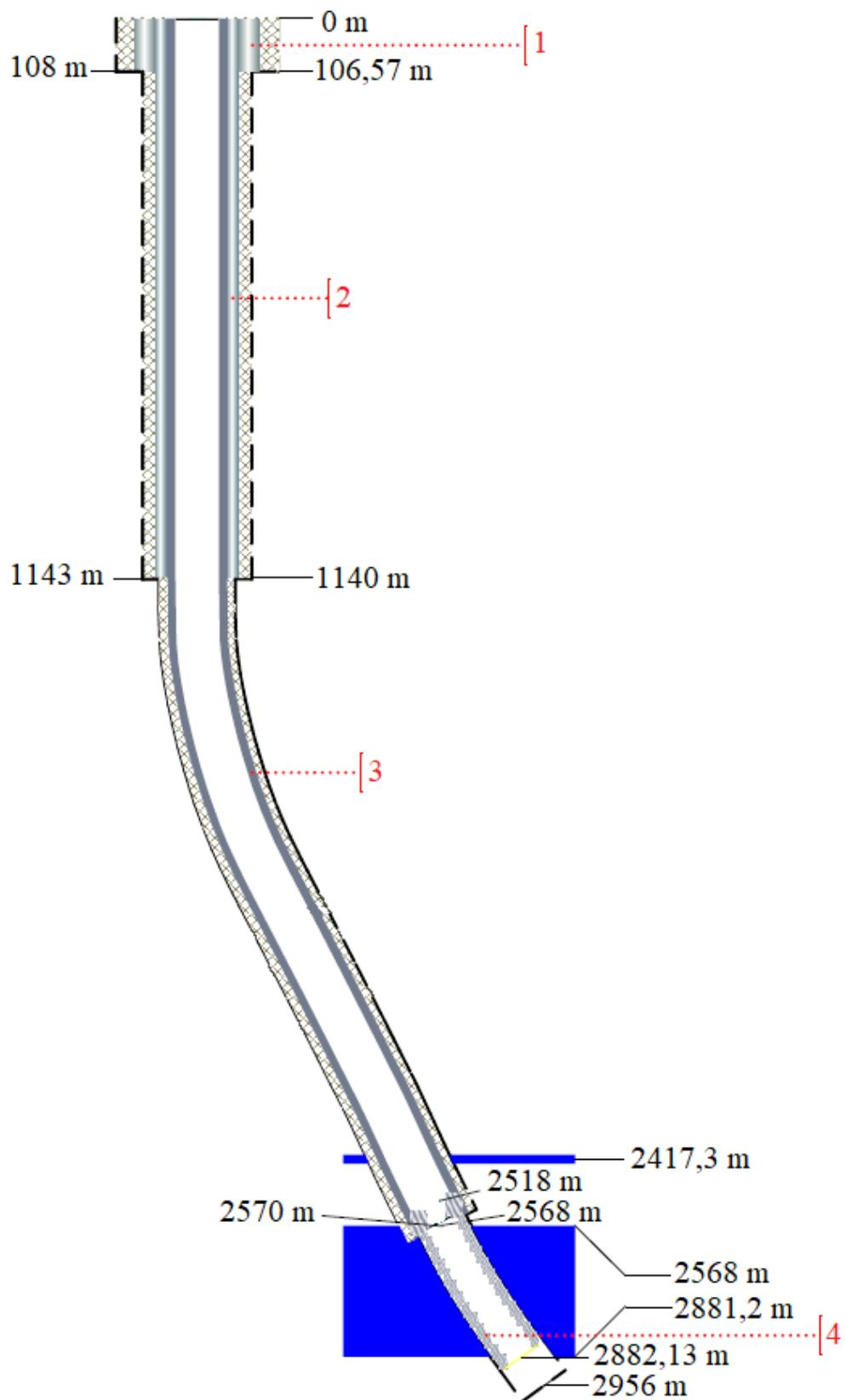
Slika 4-3. Konstrukcija bušotine VC-1A (Elezović et al., 2018)
