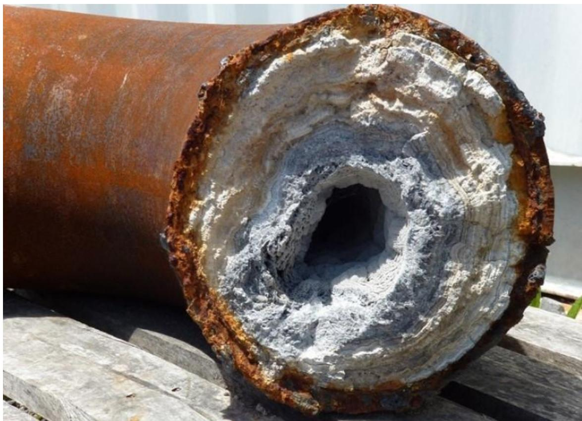
**Slika 3-7.** Kamenac nastao od silicijevog dioksida (www.mmu.ac.uk, 2019)
