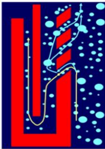
Slika 2-11. Statički separator plina (Fetoui, 2017 c)
