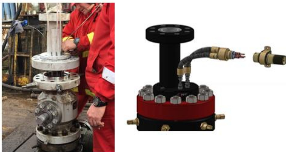
Slika 4-24. Pokrovna prirubnica i trožilni kabel (INA d.d., 2019)
