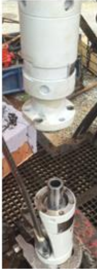
Slika 4-10. Zadizanje protektora i zamjena brtvi (INA d.d., 2019)
