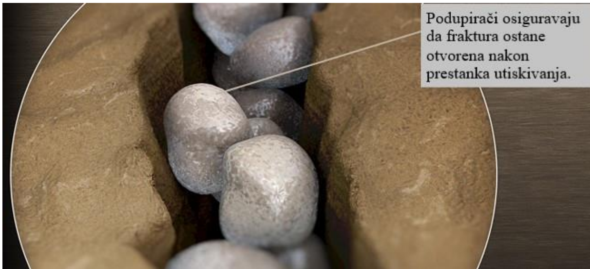
Slika 4-1. Shematski prikaz podupirača u stvorenoj pukotini (www.jasonmunster.com, 2020)
