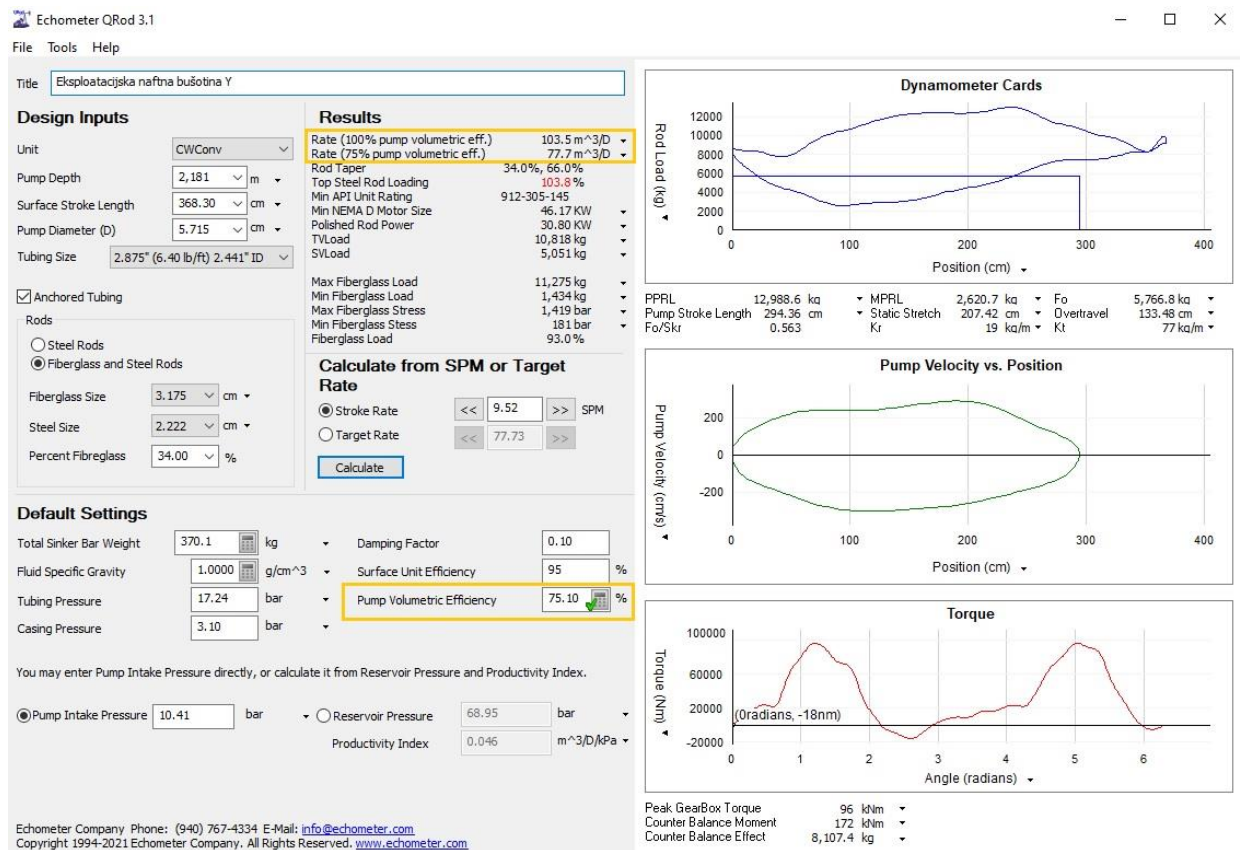
Slika 4-9. Dizajn sustava za eksploatacijsku naftnu bušotinu Y
