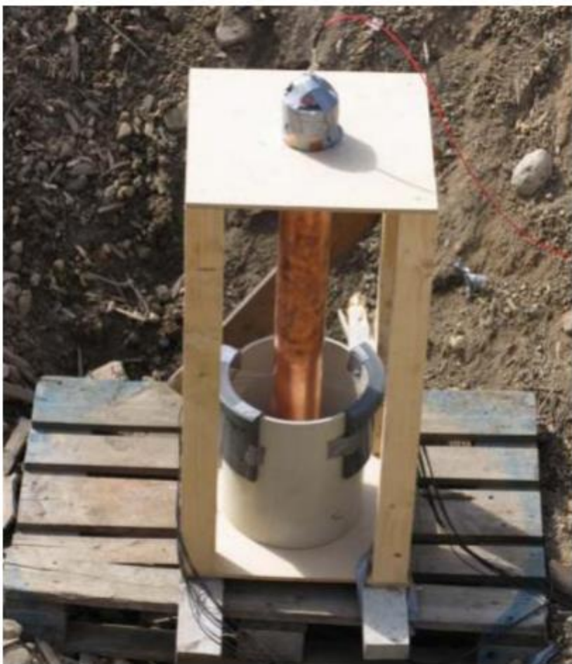
Slika 6-3: Test ekspanzije cilindra (Esen i suradnici, 2005)
