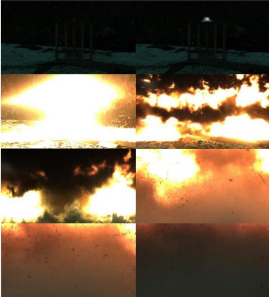
Slika 6-4: Detonacija u ekspanzijskom cilindar testu snimljena brzom kamerom (Topkaroglu, 2014)
