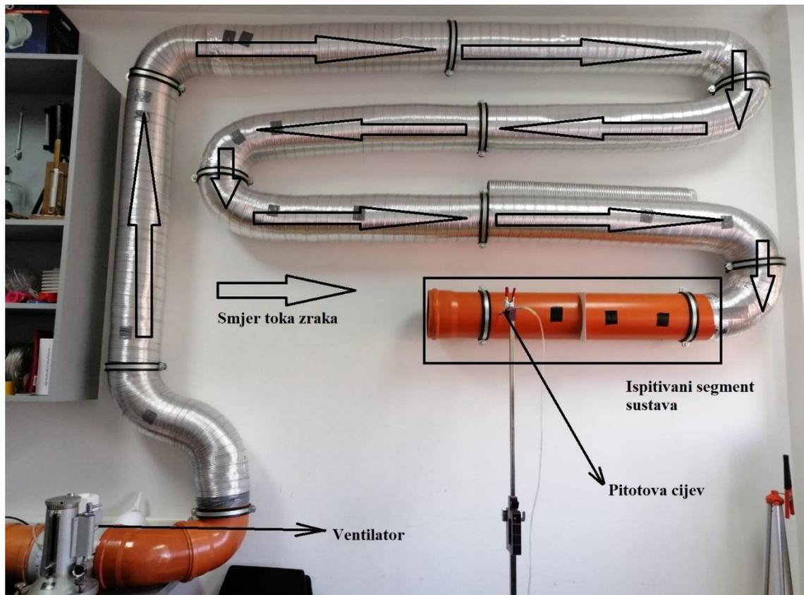
Slika 3-3 Sustav za laboratorijsko ispitivanje
