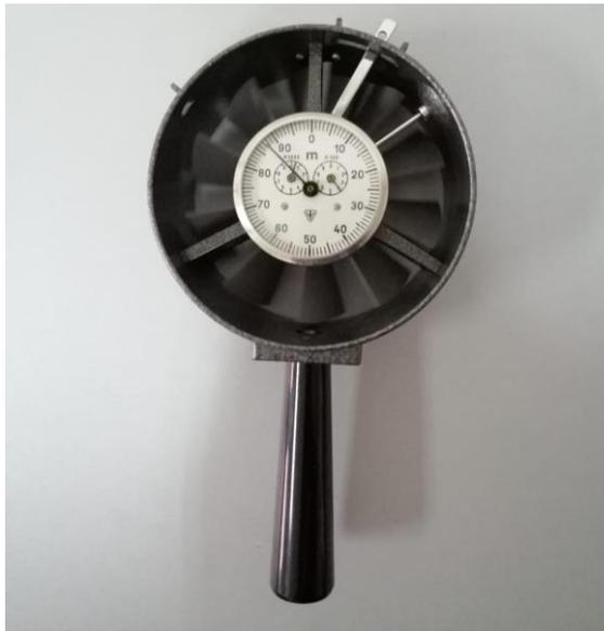
**Slika 3-17** Krilni anemometar
