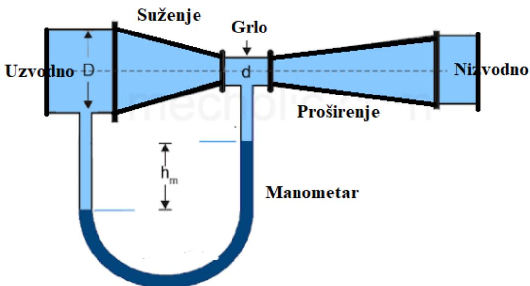
**Slika 3-2** Tok fluida kroz venturijevu cijev (MURTHI, 2018)
