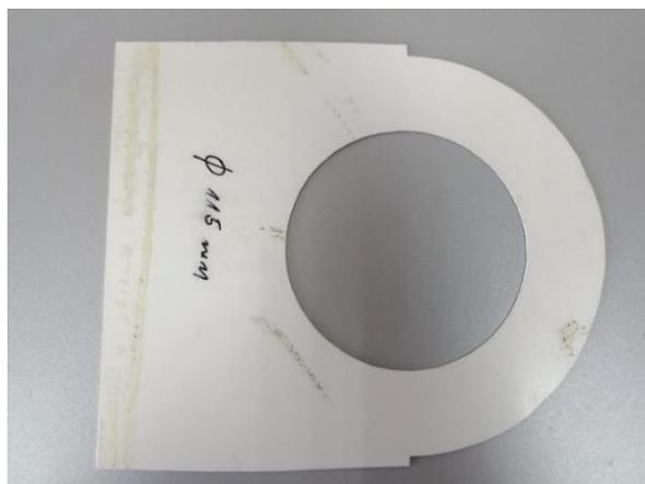
Slika 3-12 Pregrada (d=115 mm)
