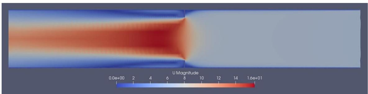
**Slika 5-8** Raspodjela brzina strujanja po cijelom ispitivanom segmentu
