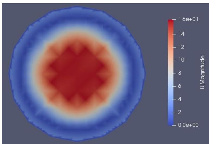
Slika 5-5 Raspodjela brzina strujanja - profil (b)
