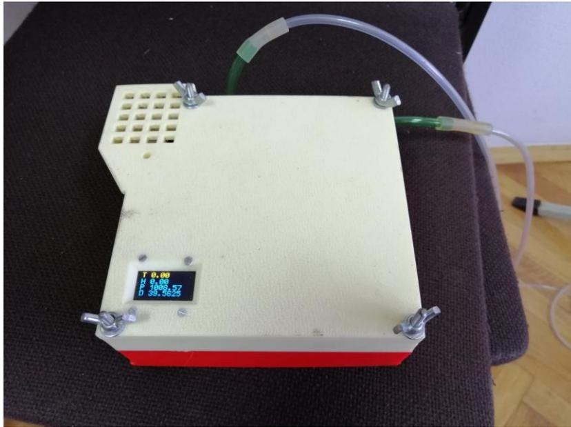
Slika 3-13 Digitalni manometar
