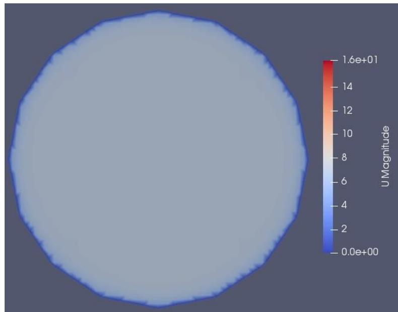
**Slika 5-7** Raspodjela brzina strujanja - profil (d)
