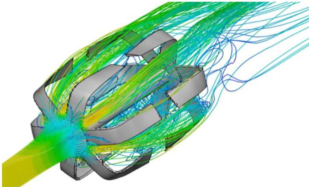
**Slika 2-1** Primjer simulacije toka zraka na turbini (GIRALDO, 2020)
