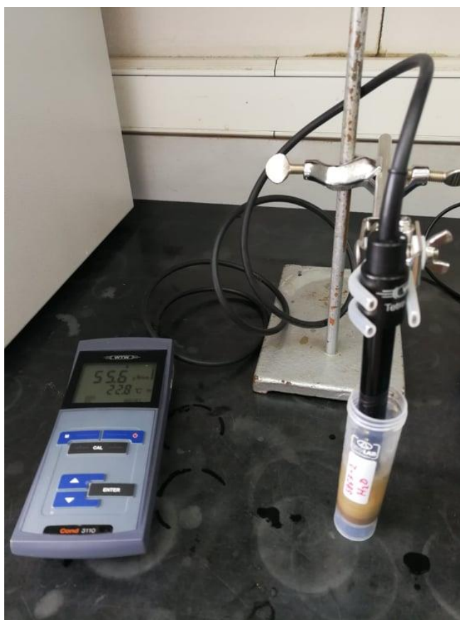
Slika 4.3. Određivanje električne vodljivosti tla uređajem WTW Cond 3110
