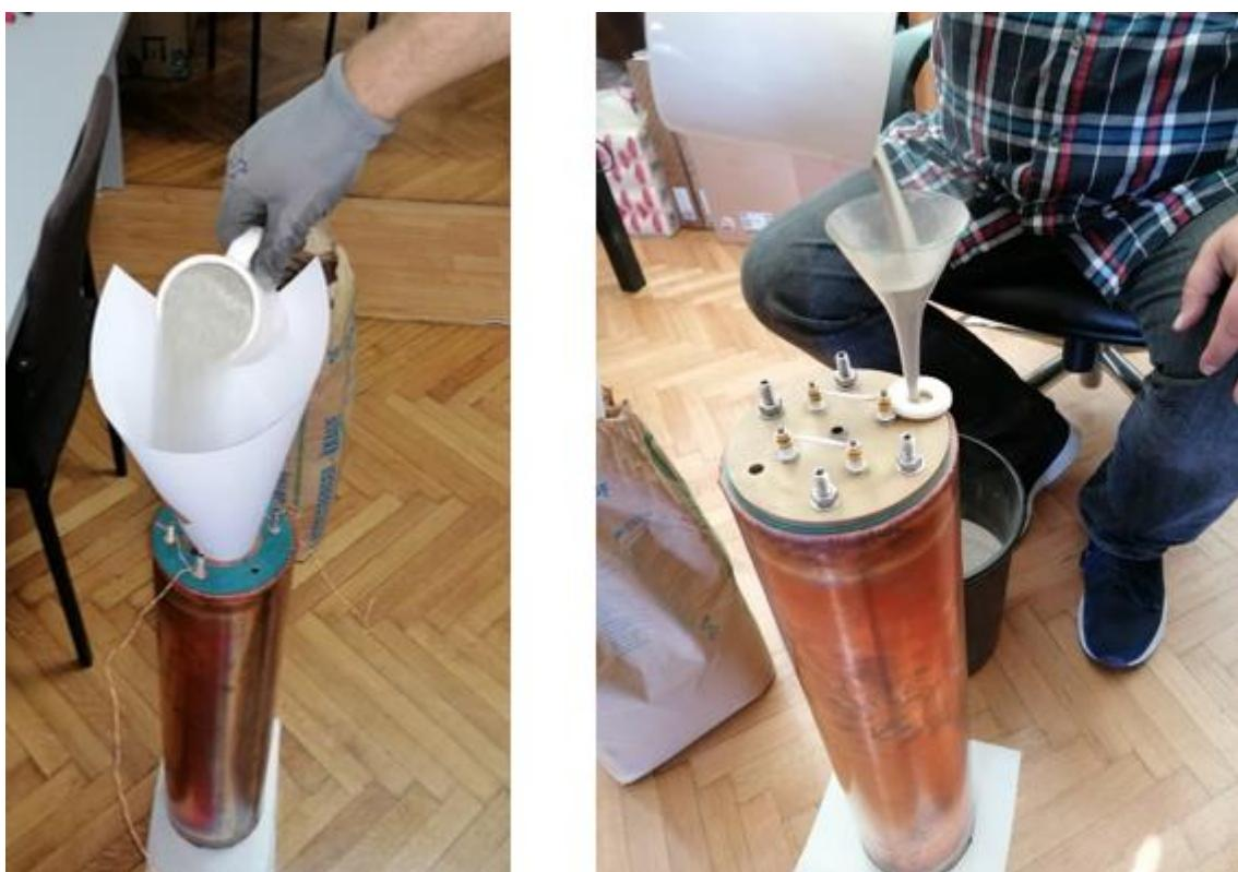
Slika 3-3. a) Ispunjavanje grijajućeg tijela kvarcnim pijeskom b) Dopunjavanje i niveličanje razine kvarcnog pijeska u grijajućem tijelu
