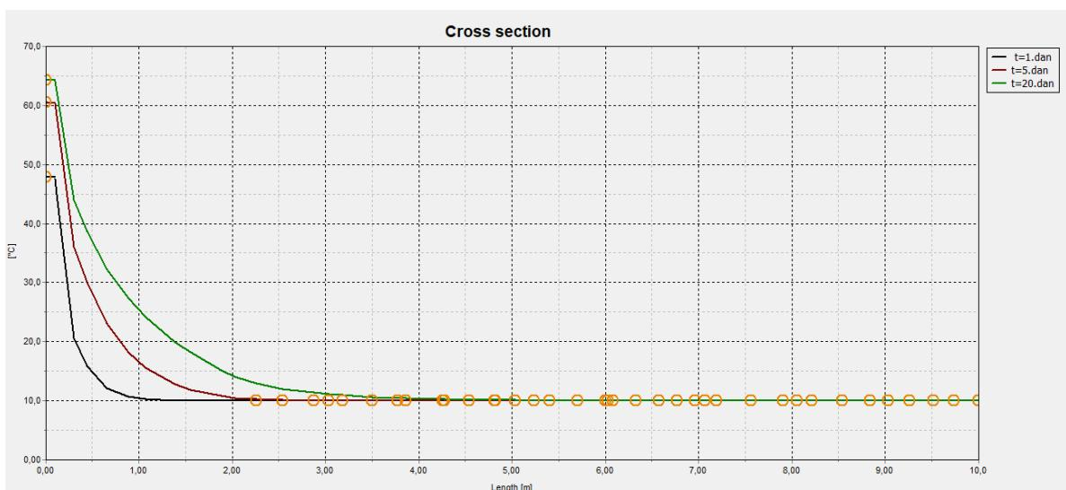
Slika 4-7. Dijagram ovisnosti temperature o udaljenosti od grijaća
