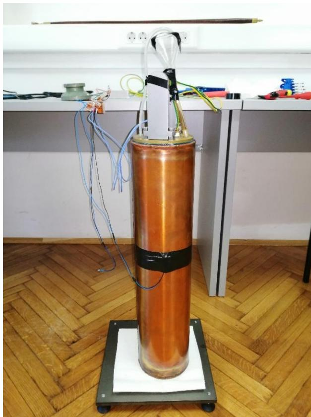
Slika 3-4. Saturacija pijeska uljem
