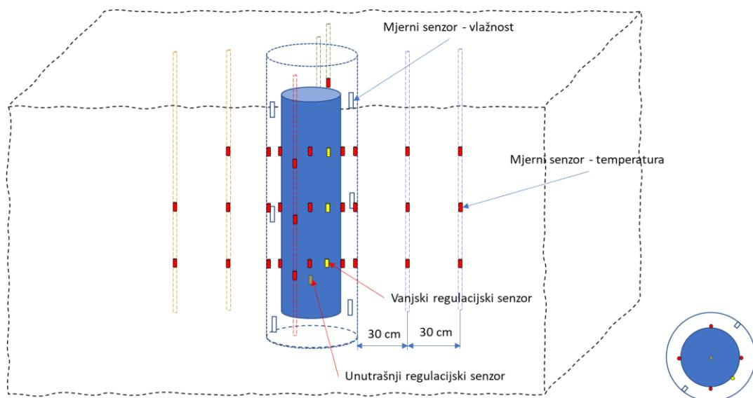
Slika 3-9. Raspored senzora za mjerjenje temperature, kontrolnih/regulacijskih senzora i senzora za vlažnost na cijelom eksperimentu
