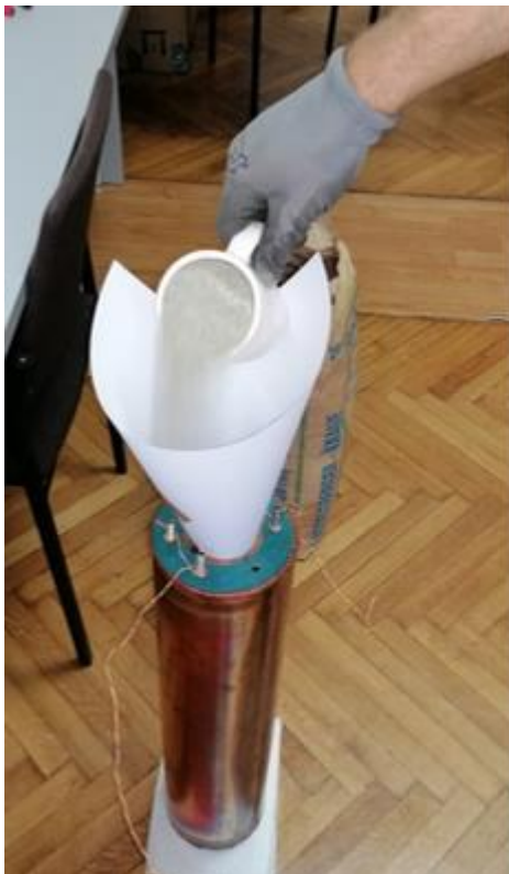
Slika 3-3. a) Ispunjavanje grijaćeg tijela kvarcnim pijeskom b) Dopunjavanje i nivelacija razine kvarcnog pijeska u grijaćem tijelu
