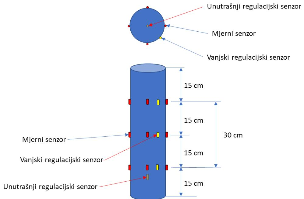
Slika 3-8. Raspored senzora za mjerjenje temperature i mjernih senzora na grijajućem tijelu
