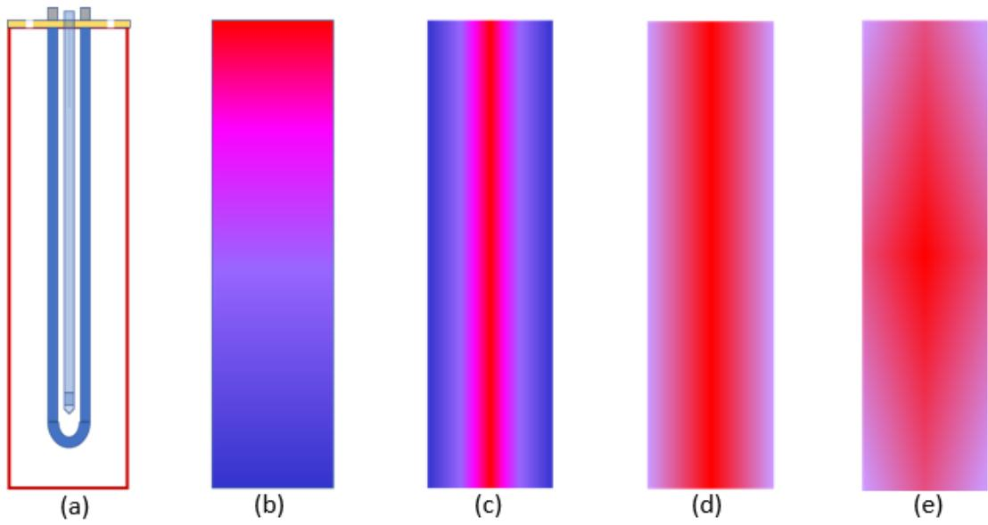
Slika 3-5. Širenje topline na grijajućem tijelu (a): (b) ispunjenim uljem, (c) ispunjenim pijeskom, (d) ispunjenim pijeskom saturiranim uljem i raspored topline na realnom spremniku s ING-om (e)
