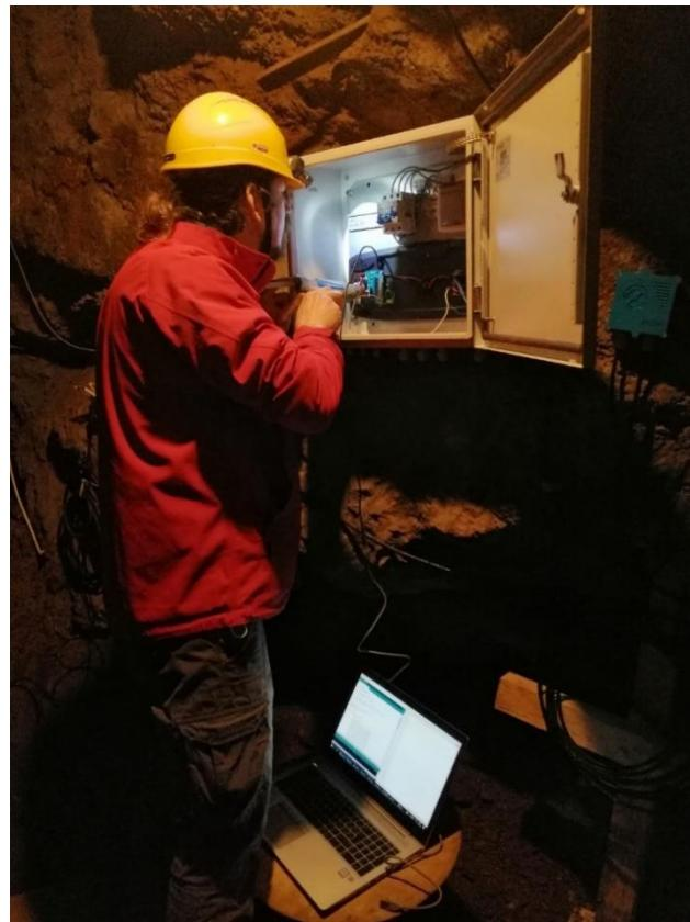
Slika 3-12. Spajanje senzora za mjerenje temperature i vlažnosti
