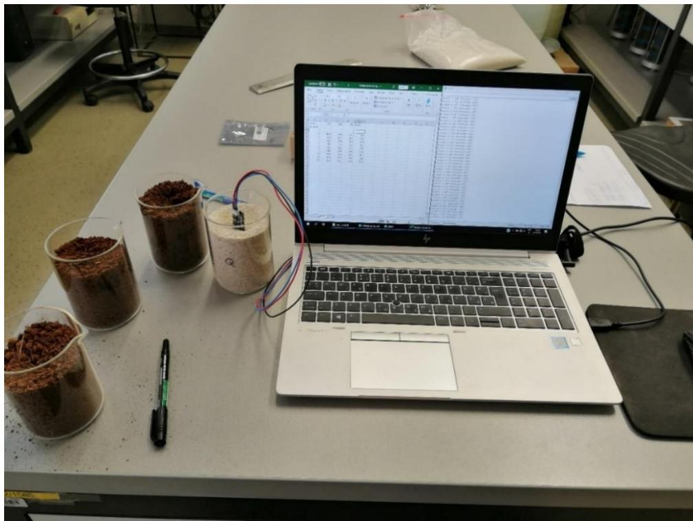
Slika 3-6. Umjeravanje senzora za mjerjenje vlažnosti
