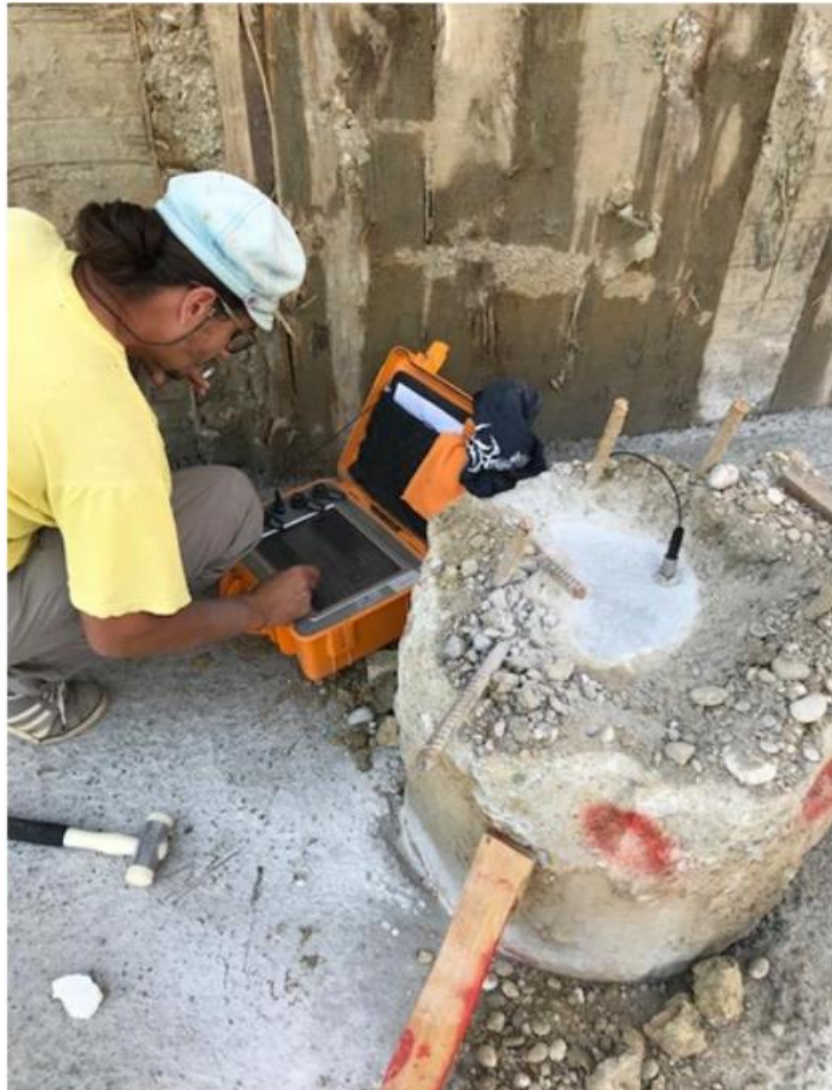
Slika 4-1 Uređaj za seizmičko ispitivanje pilota
