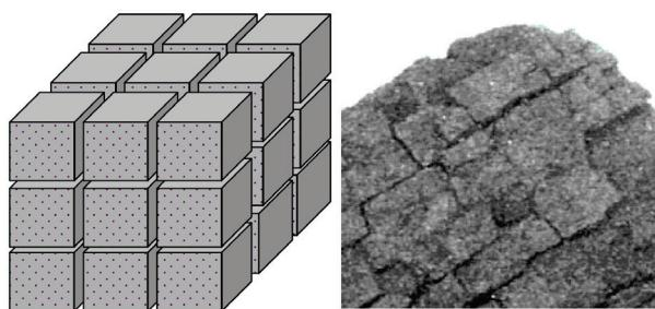
Slika 2a i 2b. Model pukotinskog sustava ugljena
