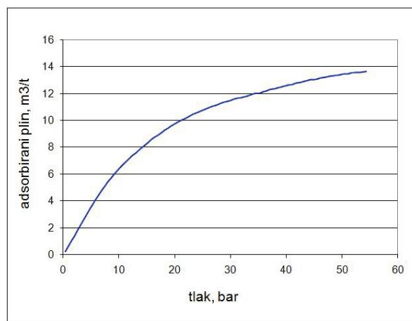
Slika 5. Mjerena Langmuirova izoterma (prilagođeno iz McLennan et al., 1995).
