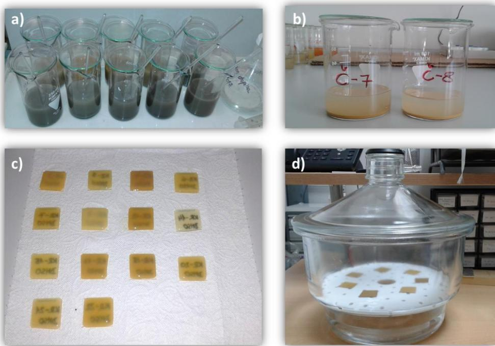
**Slika 18** Prikaz nekih od osnovnih koraka u pripremi uzoraka za mineralošku analizu: a) otapanje kalcita u uzorcima, b) taloženje glinovite frakcije iz suspenzije, c) glina nakapana na stakalca, d) naparivanje orientiranih uzoraka frakcije manje od 2 µm etilen glikolom.
