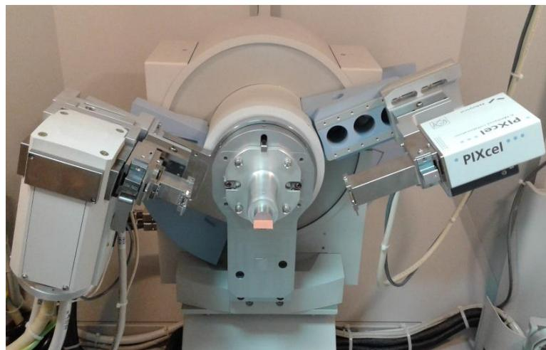
**Slika 16** Rendgenski difraktometar u vlasništvu Hrvatskog geološkog instituta s vertikalnim  $\theta - \theta$  goniometrom, keramičkom rendgenskom Cu-cijevi, PiXcel-ovim detektorm i odgovarajućim nosačima za uzorke (na slici je vidljiv nosač za orijentirane uzorke). Prilikom snimanja uzorak miruje, dok rendgenska cijev i detektor rotiraju oko uzorka.
