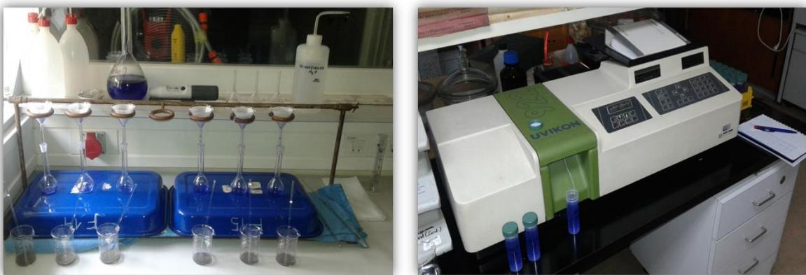
**Slika 22** Filtriranje smjese uzorka i Cu-trien kompleksa kroz filter papir u tikvice od 50 ml (slika lijevo) i mjerjenje apsorbance na spektrofotometru (slika desno).
