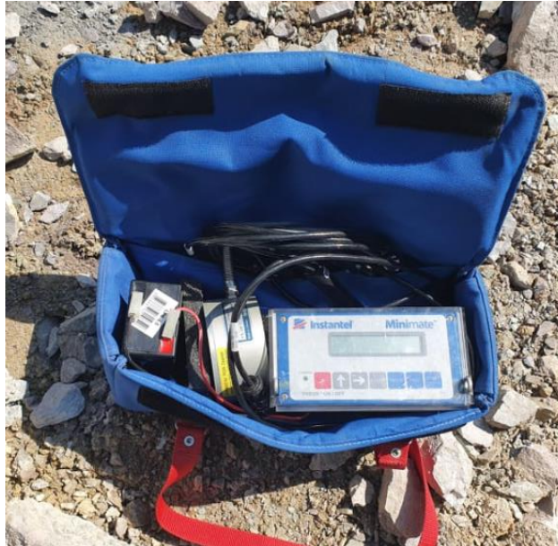
Slika 3.17. Seizmograf Instantel Minimate
