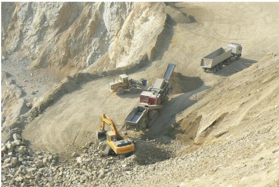
Slika 3.22. Način utovara u drobilicu bagerom i transport materijala (Pranjić et al, 2019)
