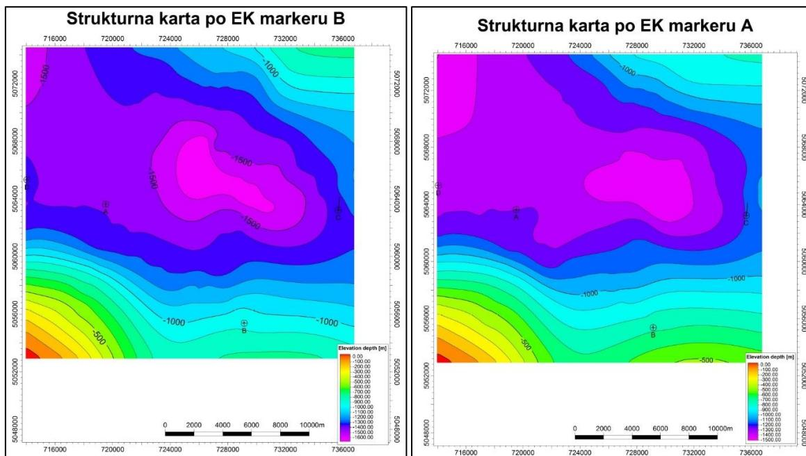
Slika 12 Strukturne karte po elektrokaračnim markerima „A“ i „B“ dobivene u softveru Petrel 2020.
