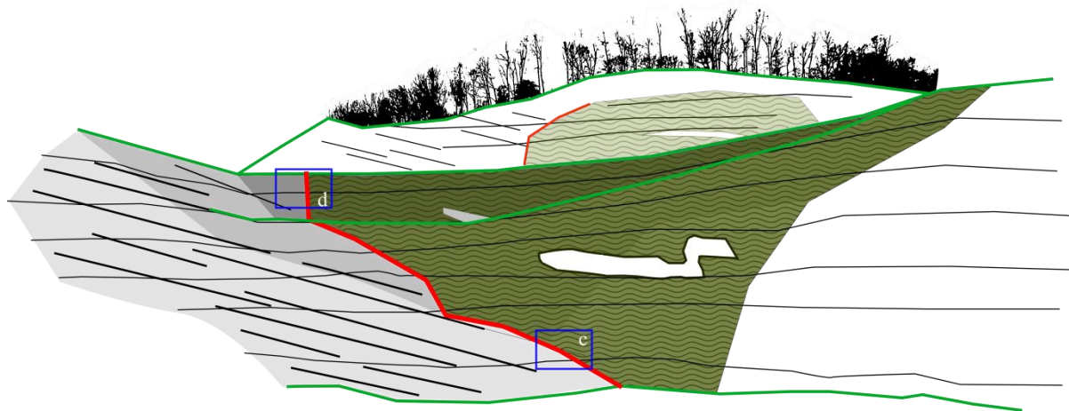
Slika 5.16 b. Interpretacija geoloških formi na lokalitetu Slatina. Kontakt serpentinita i amfibolita. Zeleno obojani – serpentiniti sa izduženim i deformiranim tijelima amfibolita (svijetla boja). Sivo obojani s prugama – masivna tijela amfibolita. Svijetlo zeleno obojani - serpentiniti u daljini na trećoj etaži. Bijelo obojani s prugama – amfiboliti u daljini na trećoj etaži.
