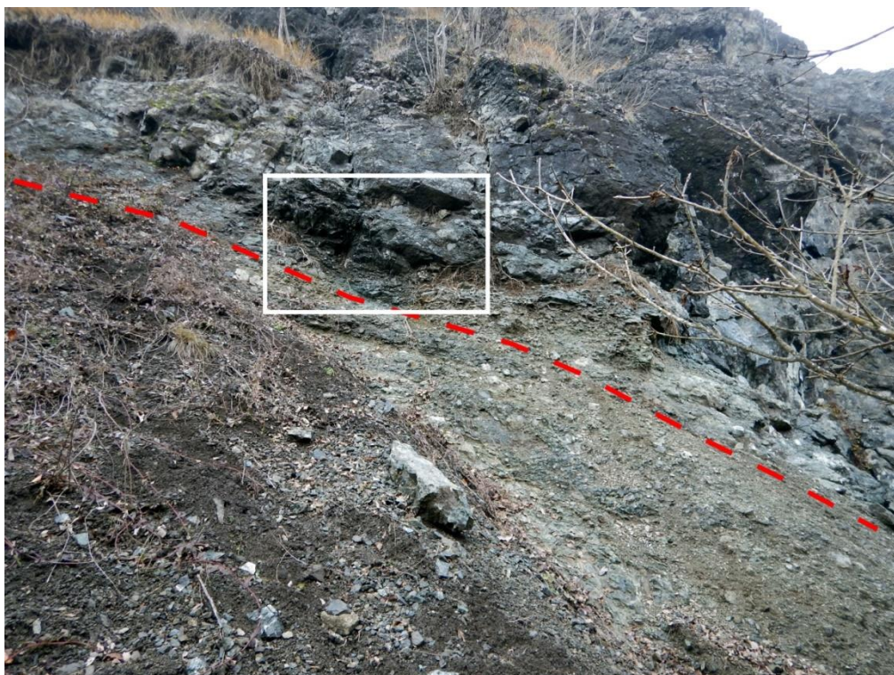
Slika 5.3. Nepravilna tijela serpentinitnih breča i crveno označena granica rasjedne zone u kojoj se nalaze izrazito kataklazirani serpentiniti. Lokalitet Ljeskovac. Polje bijelog pravokutnika prikazano je uvećano na slici 5.4.
