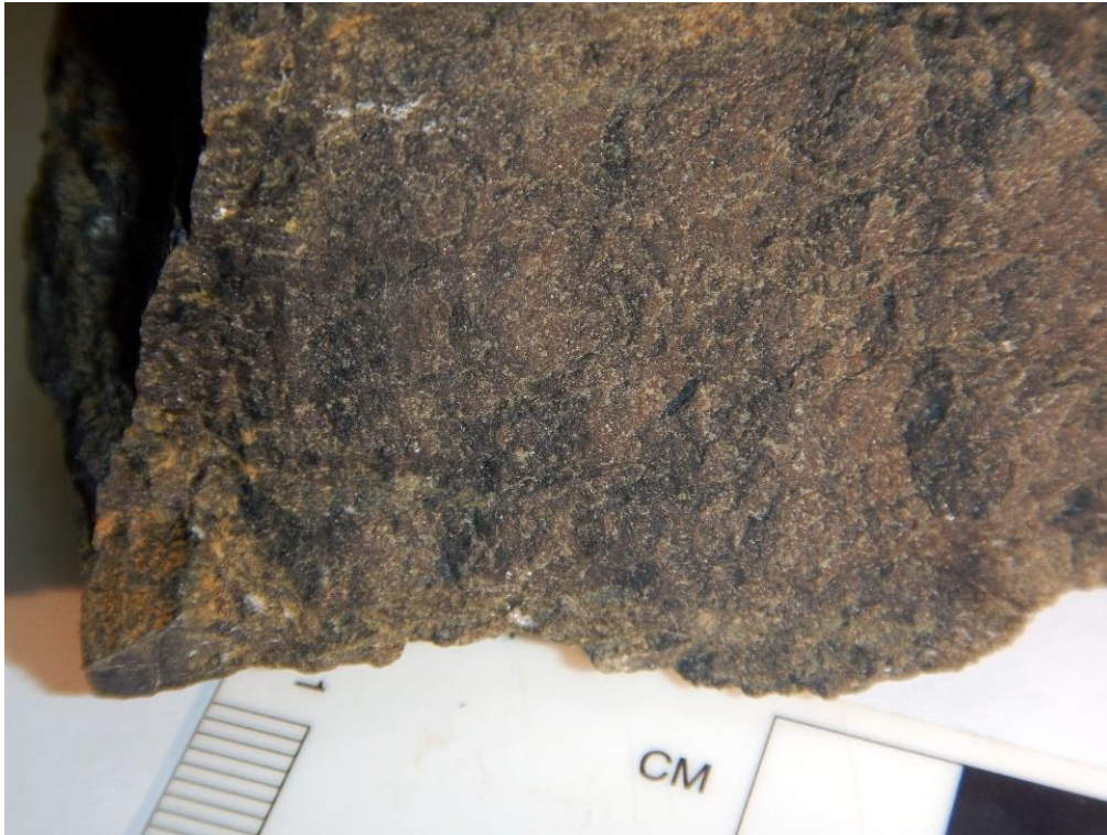
Slika 5.63. Dunit Gv-7. Homogena tekstura s vrlo sitnim zrnima amfibola.
