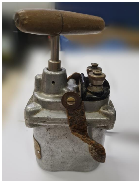
Slika 2-8 Dinamo električni stroj za paljenje električnih detonatora
