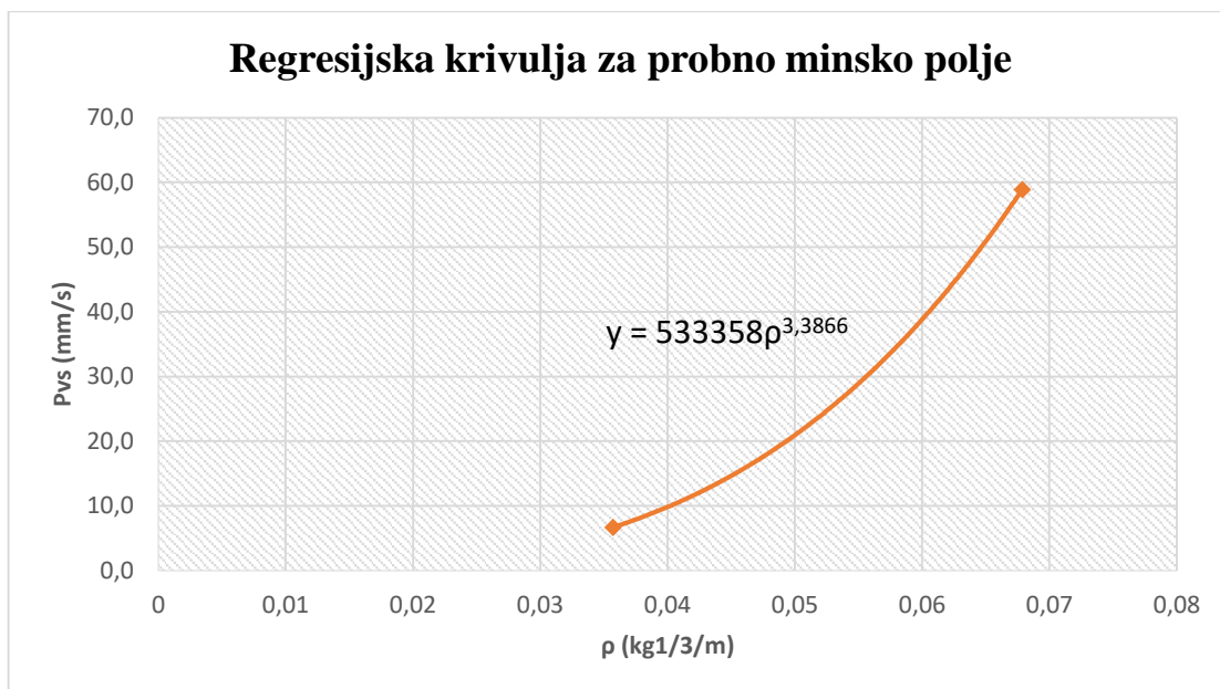
Slika 7-1 Grafički prikaz regresijske krivulje za probno minsko polje
