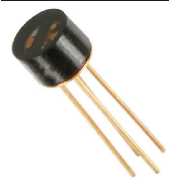
Slika 5-3. Infracrveno optičko osjetilo OPB710 (Digikey, 2021.)
