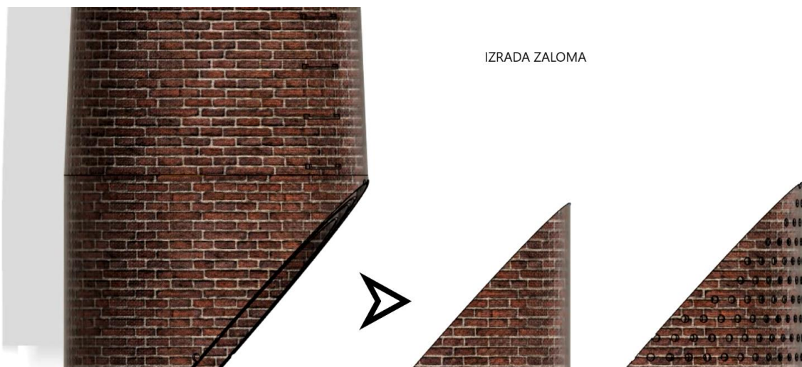
Slika 5-1-4. Model izrade zaloma (vlastiti model)
