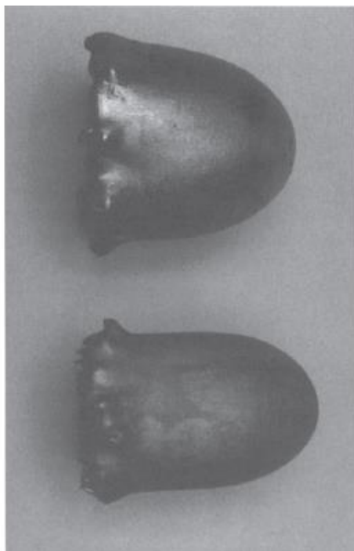
Slika 6-13 EFP od Armco željeza. Gornji projektil: eksploziv sastava B. Donji projektil: Oktol (Weickert, 1998)
