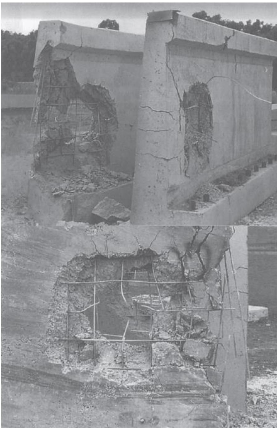
**Slika 6-27** Prikaz armiranobetonskih zidova probijenih eksplozivno oblikovanim projektilom (Weickert, 1998)
