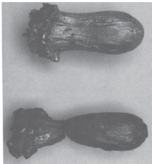
Slika 6-14 EFP od tantaluma. Gornji projektil: eksploziv sastava B. Donji projektil: Oktol (Weickert, 1998)
