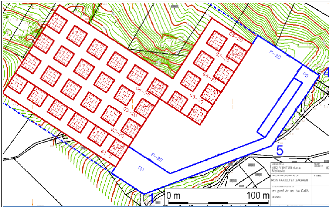
Slika 3-4. Završno stanje razvoja podzemnog kopa u prvoj varijanti (Galić i dr., 2020.)
