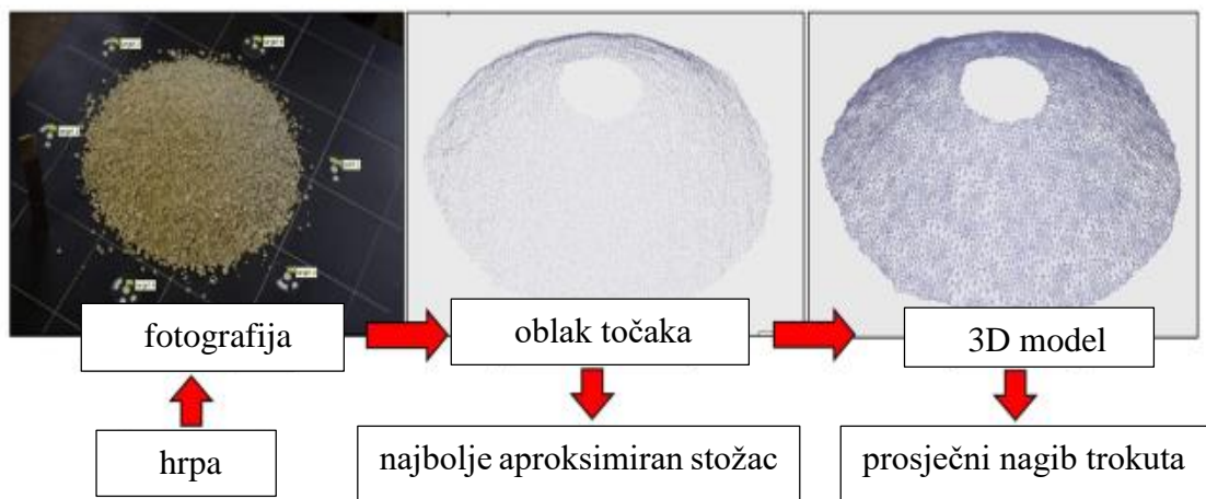
Slika 3-2 Cjelokupni kronološki postupak izrade 3D modela iz digitalne fotografije (Klanfar i dr., 2021.)
