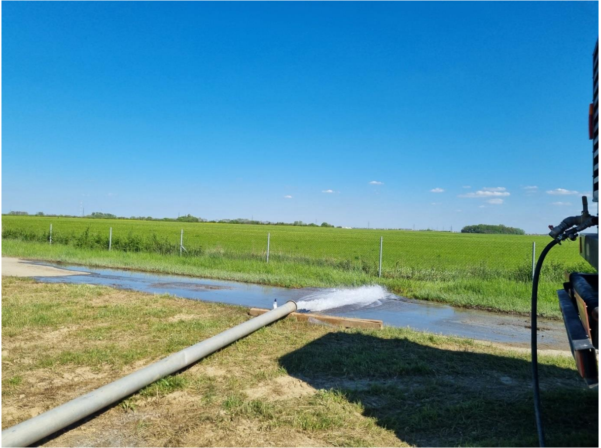
Slika 16: Blenda izbacuje čistu vodu
