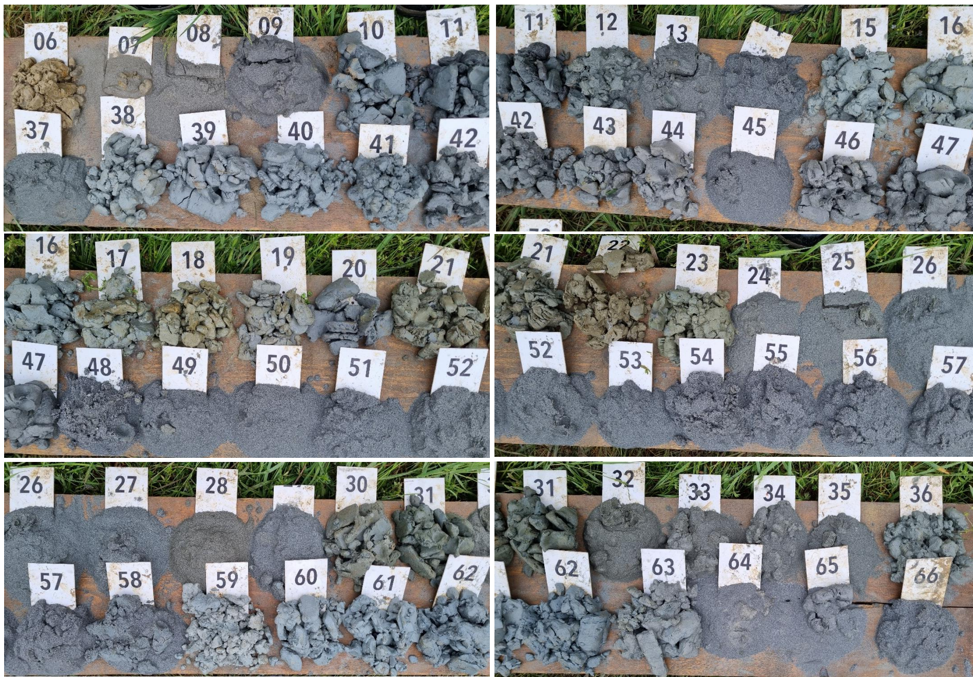
Fotografije uzoraka nabušene litologije za zdenac Z-14 na Crpilištu Vinogradi
