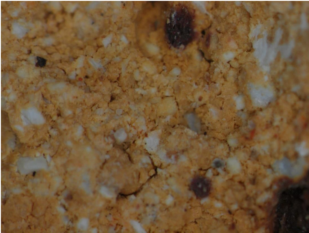
Slika 3-6. Uzorak S2, povećanje 63x, uzorak je s lokacije tvornice stakla u Lipiku, cigla žute boje
