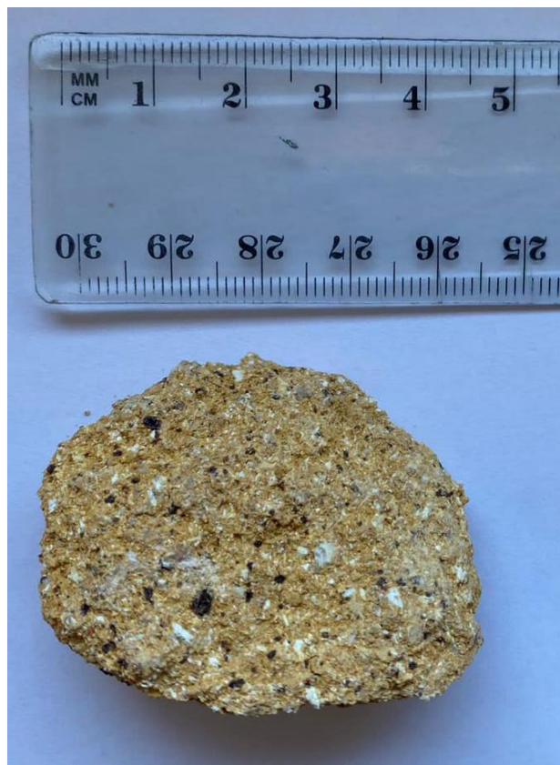
Slika 3-2. Uzorak S2, klasa 64/32 mm
