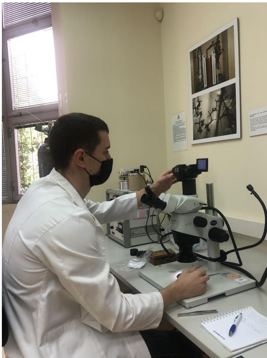
Slika 3-5. Pregledavanje uzoraka na stereomikroskopu Olympus SZX10
