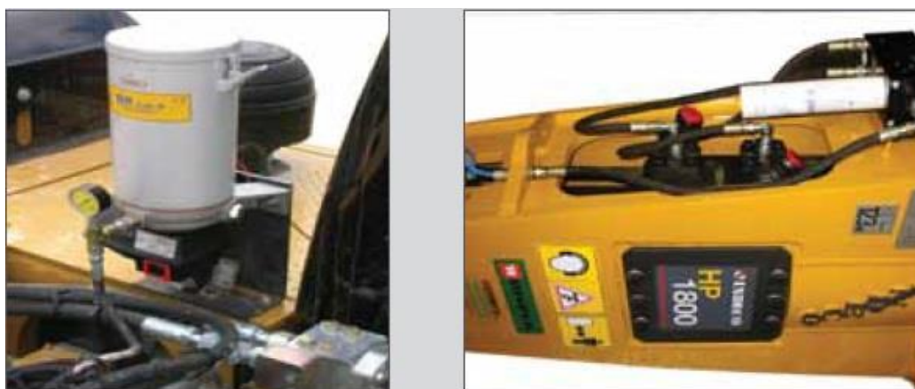
Slika 3-5. Sustav automatskog podmazivanja čekića (Amato i dr., 2013.)
