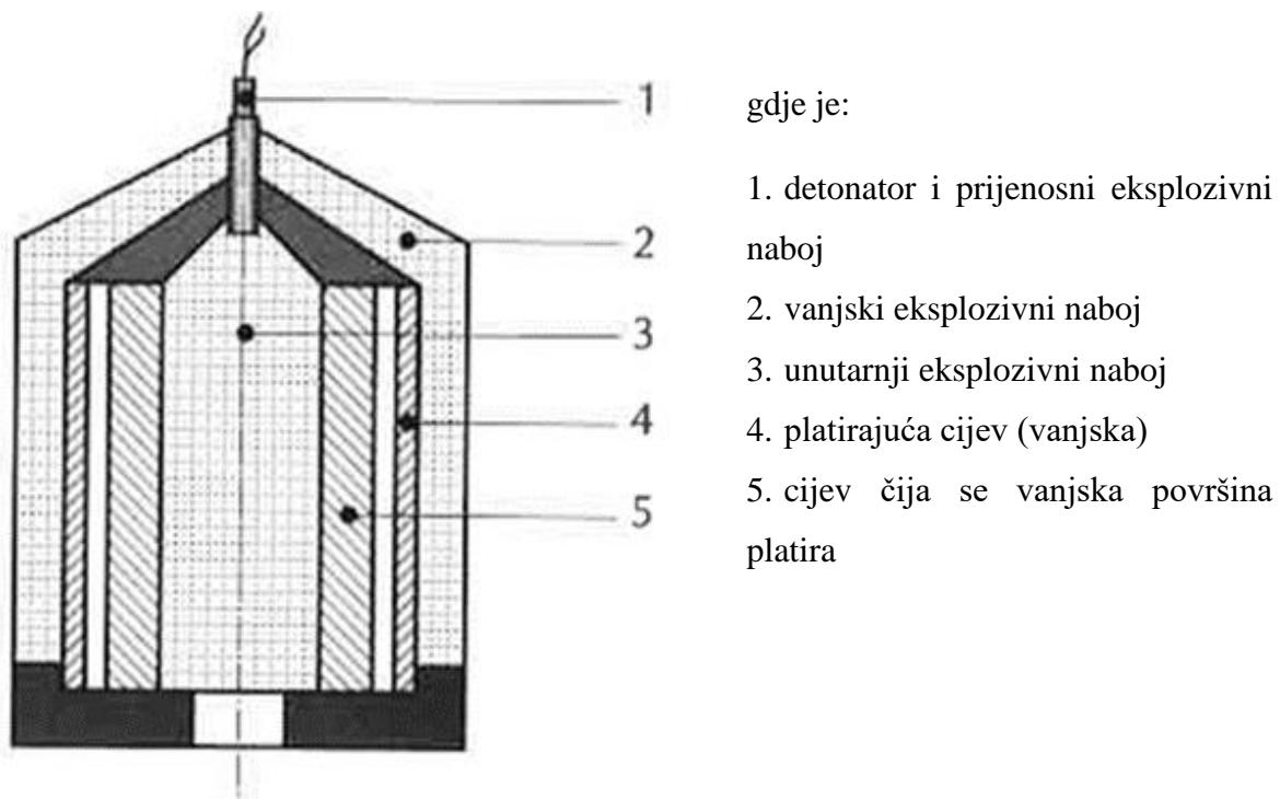
Slika 4-9. Platiranje vanjske cilindrične površine korištenjem dvaju eksplozivnih naboja (Sućeska 2001)
