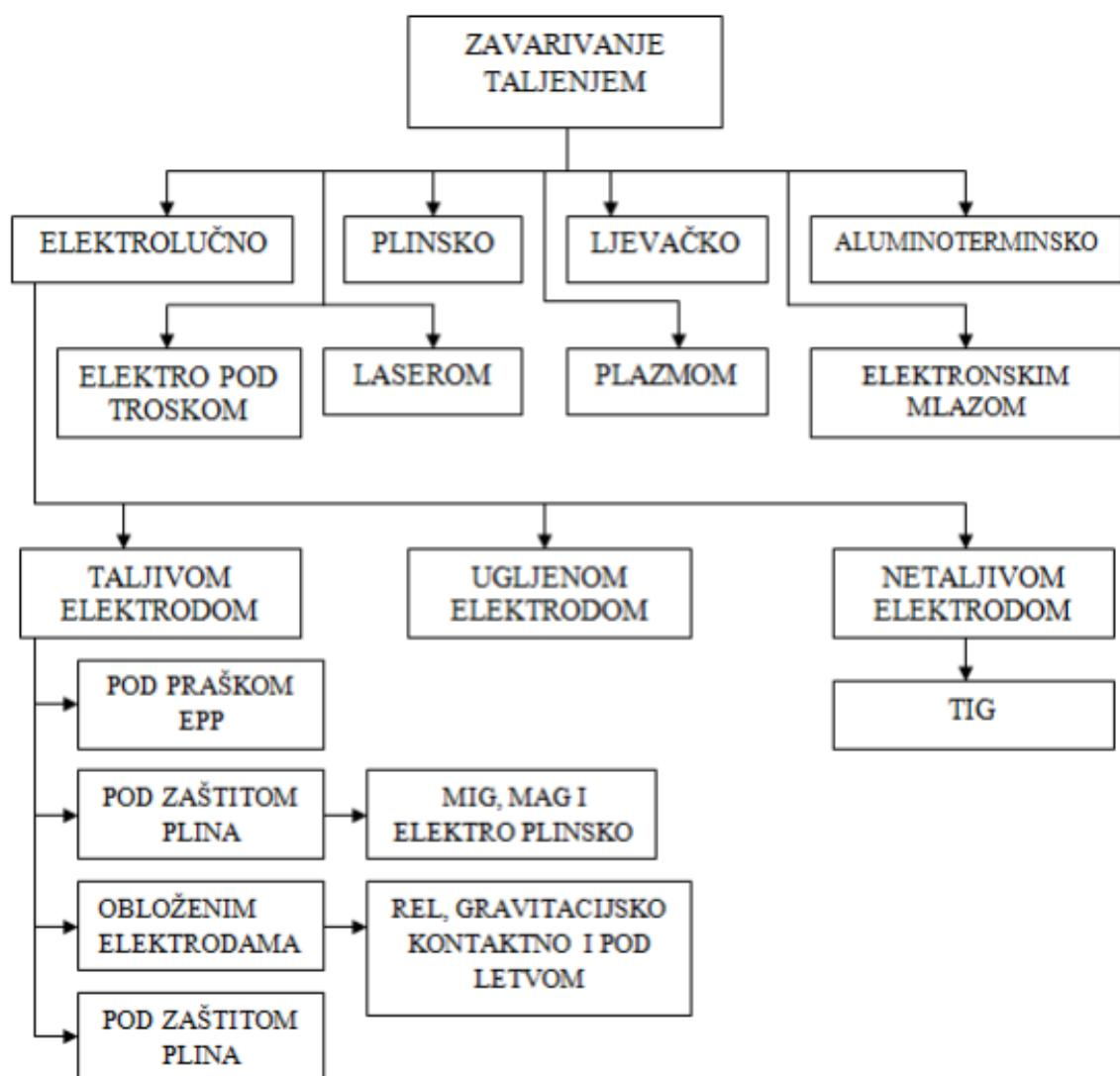
Slika 2-4. Podjela postupka zavarivanja taljenjem (Pondt, 2015)
