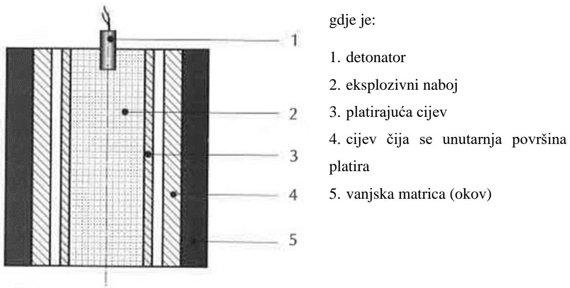
Slika 4-10. Platiranje unutarnje površine cijevi (Sućeska 2001)
