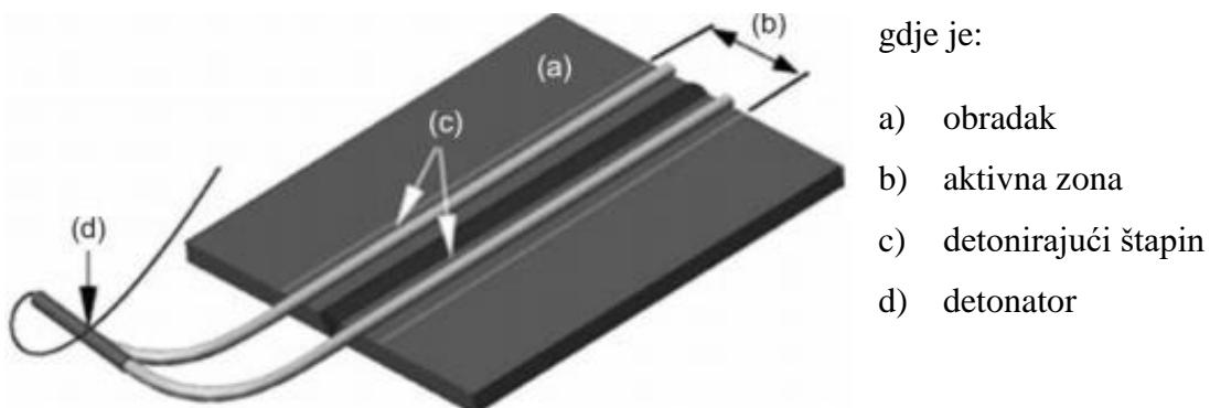
**Slika 3-10.** Paralelno postavljanje štapina (Garcia-Kacomo et al 2010)
