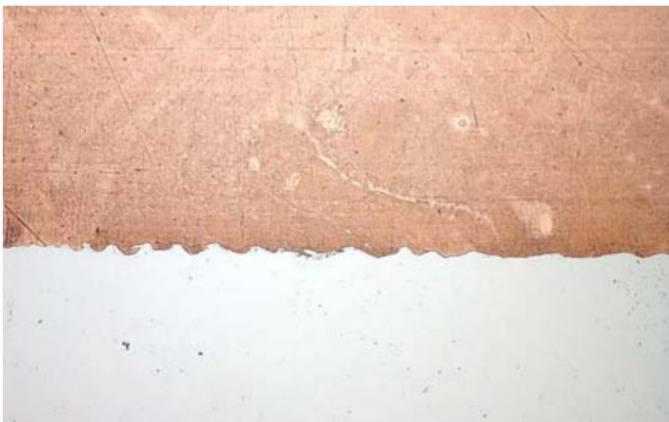
Slika 4-4. Spoj bakra i čelika nastao zavarivanjem metala eksplozivom (Akbari-Mousavi, Al-Hassani, 2008).
