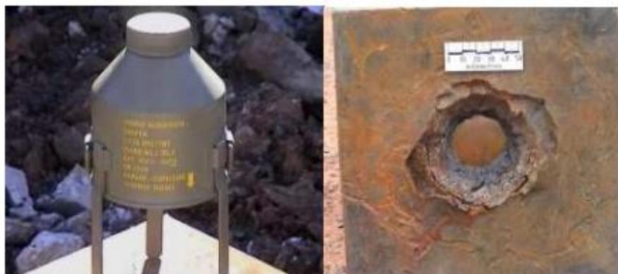
**Slika 3-7.** Konusni kumulativni naboј i perforacija nakon detonacije (Bohanek i sur., 2013)
