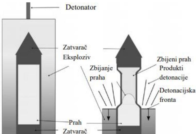
**Slika 3-12.** Kompaktiranje prahova primjenom cilindra (Farinha et al. 2009)
