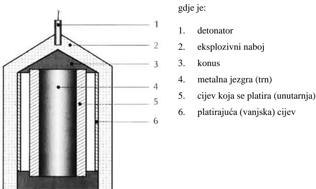
Slika 4-8. Platiranje vanjske cilindrične površine (Sućeska 2001)
