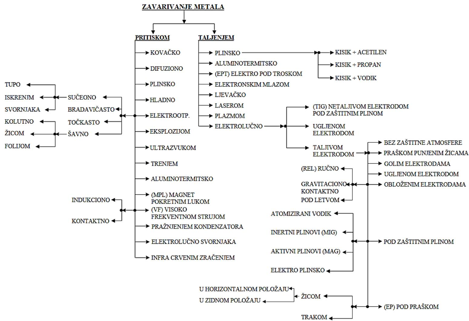
Slika 2-6. Detaljna podjela metoda zavarivanja (Pondt, 2015)
