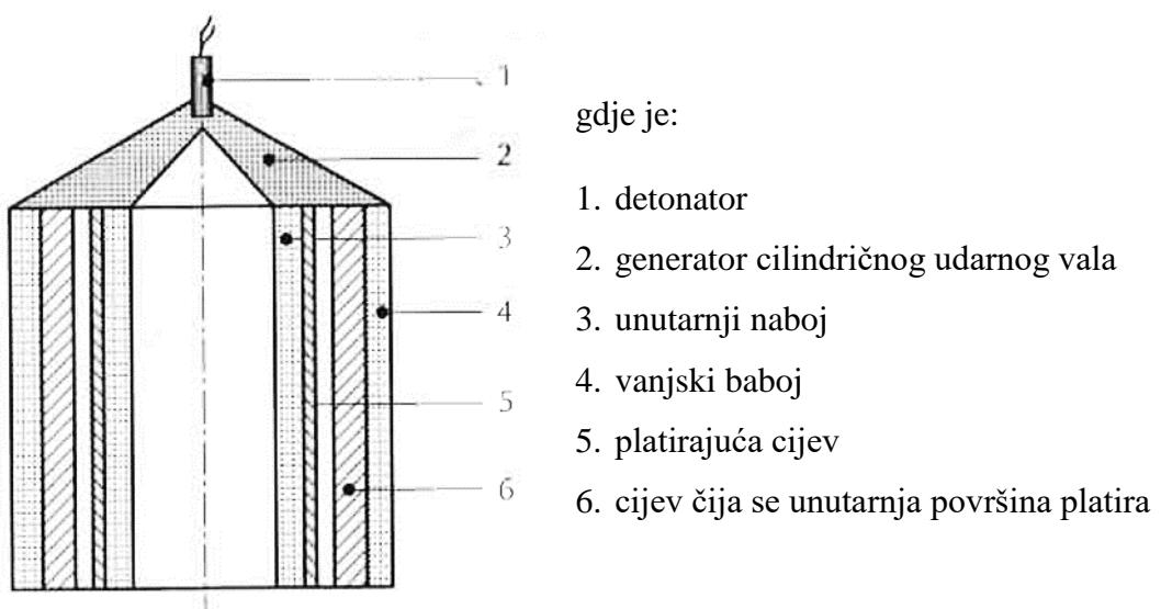
Slika 4-11. Platiranje unutarnje površine cijevi velikog promjera (Sućeska 2001)
