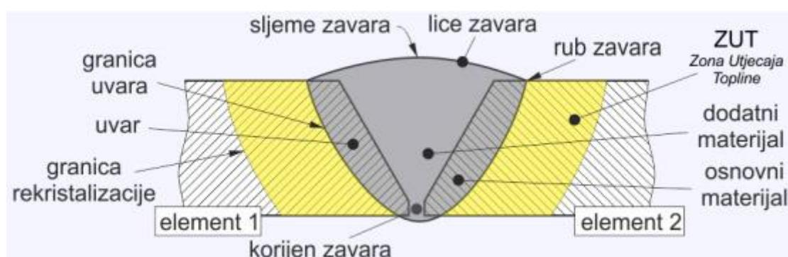
Slika 2-1. Zavareni spoj nastao taljenjem i nazivi dijelova zavarenog spoja
