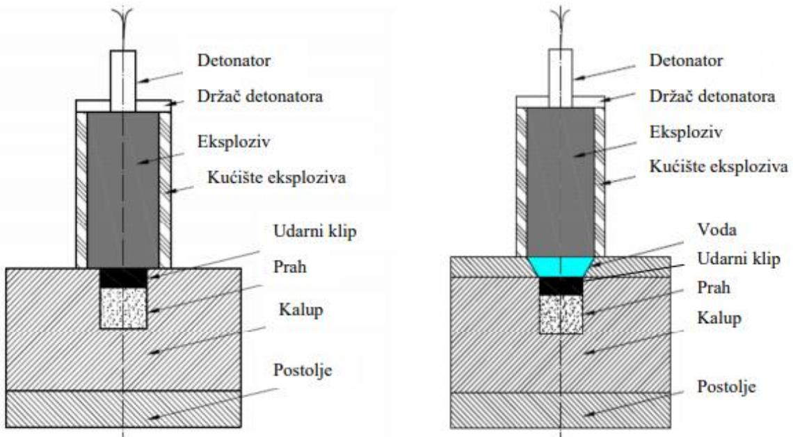
**Slika 3-11.** Kompaktiranje prahova metodom udarnog klipa (Zohoor & Mehdipoor 2009)
