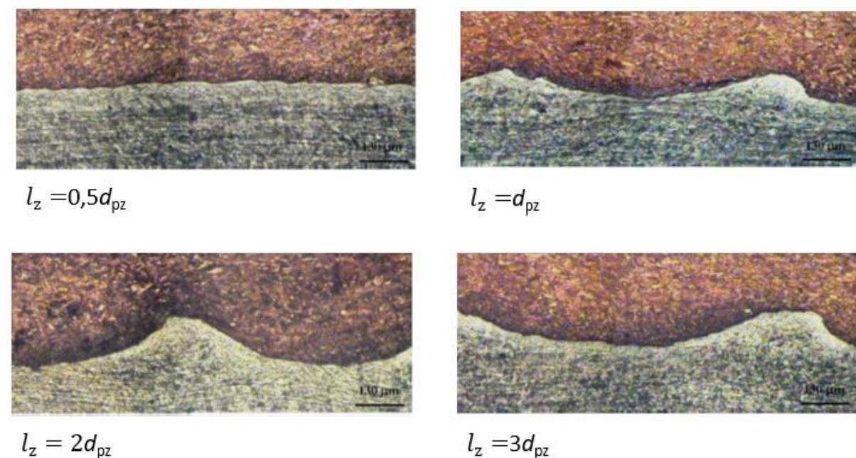
**Slika 4-6.** Utjecaj udaljenosti između dviju ploča na oblik spoja (Durgutlu i sur., 2008).
