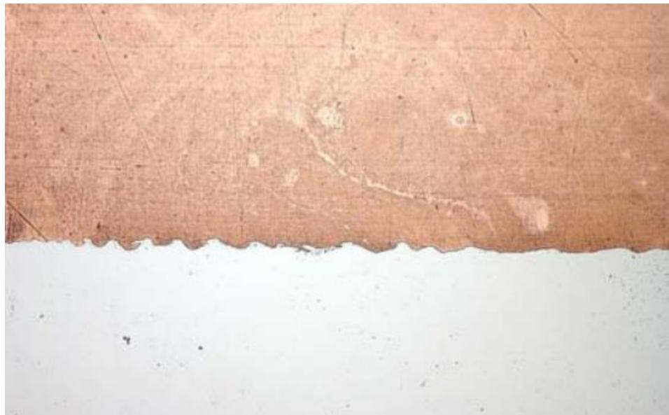
**Slika 4-4.** Spoj bakra i čelika nastao zavarivanjem metala eksplozivom (Akbari-Mousavi, Al-Hassani, 2008).
