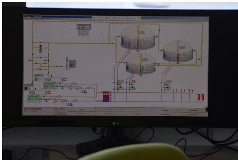
Slika 4-7. Monitoring bioplinskog postrojenja preko računala iz centralne sobe ( https://prigorski.hr , 2016)
