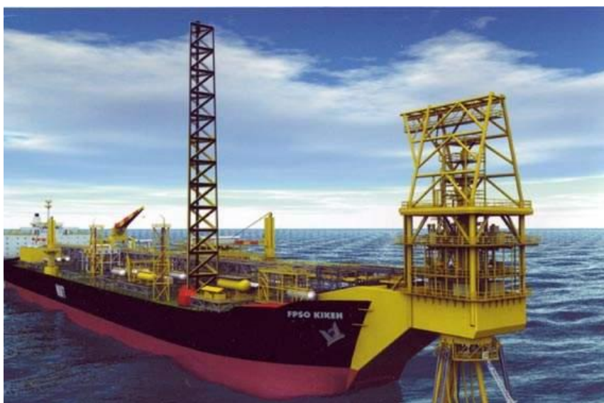
Slika 3-29. FPSO Kikeh s vanjskim sustavom za proizvodnju i sidrenje na pramcu (Offshore Technology, 2008b)
