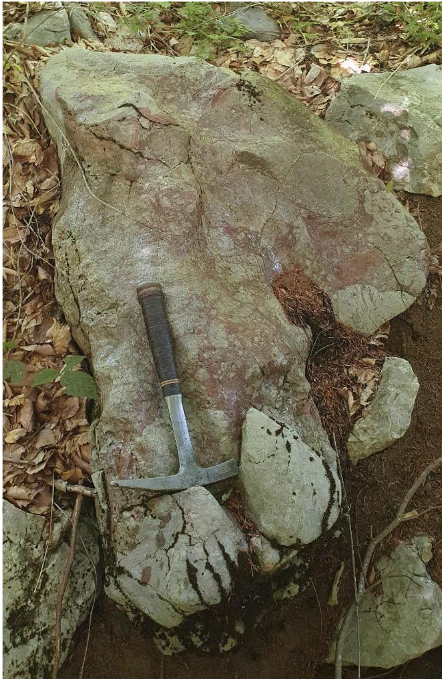
Slika 12 Terenska fotografija vapnenačke breče koja prikazuje boju klasta i matriksa
