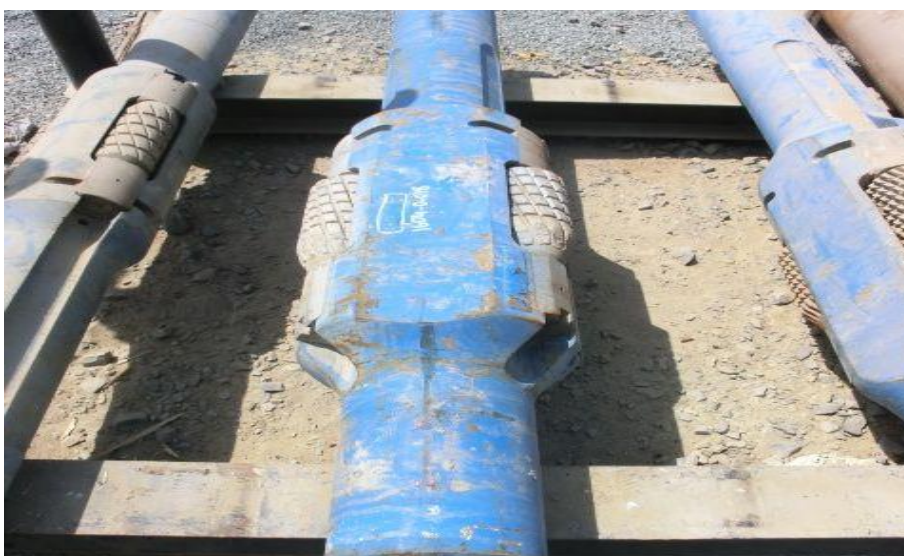
Slika 2-5. Proširivač s tri žrvnja (rigfinder.com, 2021)
