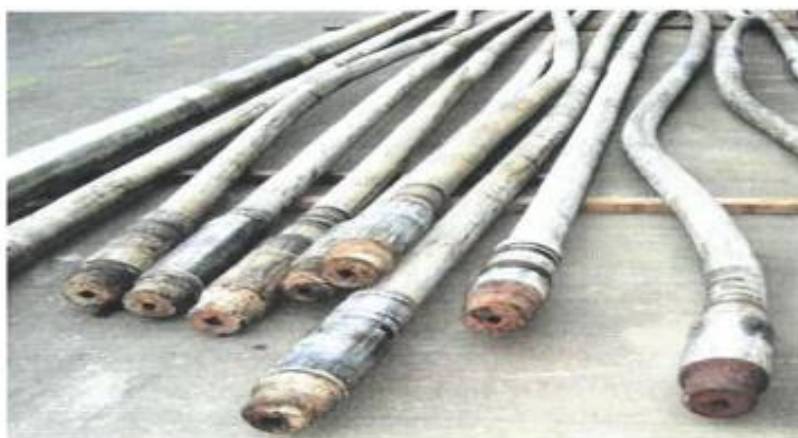
Slika 3-2. Iskrivljene bušaće šipke (Black Diamond, 2017)
