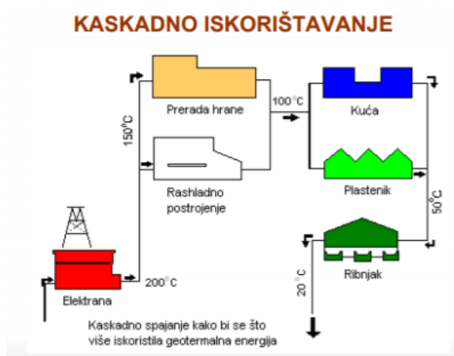
Slika 5-2. Prikaz kaskadnog korištenja geotermalne energije (Energetski institut Hrvoje Požar, 2010)
