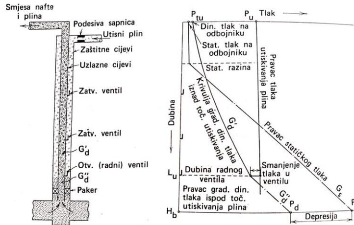
**Slika 3-2.** Shematski prikaz djelovanja neprekidnog lifta (Zelić, 1986)
