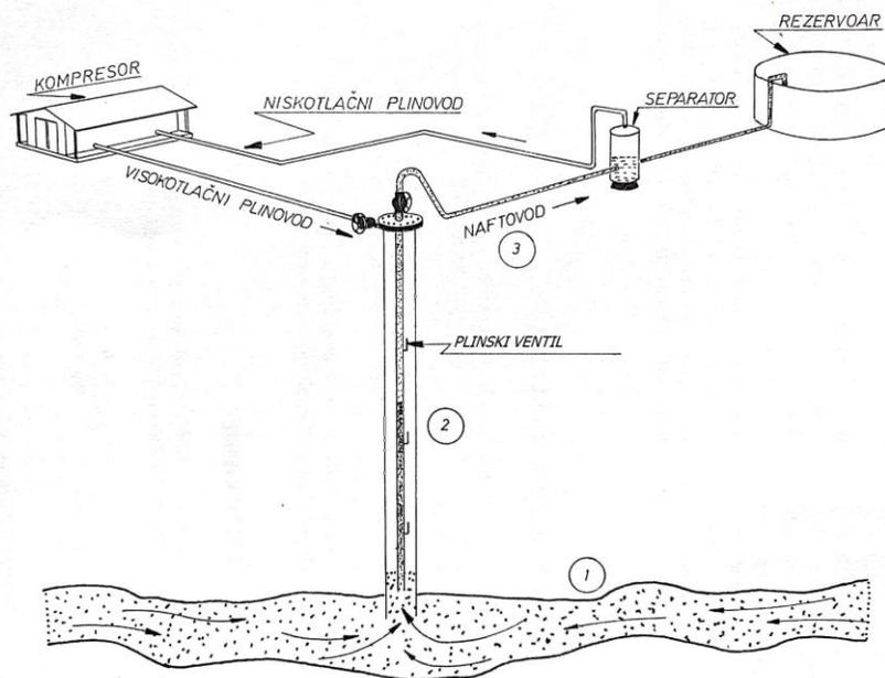
Slika 2-1. Shema sustava za plinski lift (Zelić, 1986)
