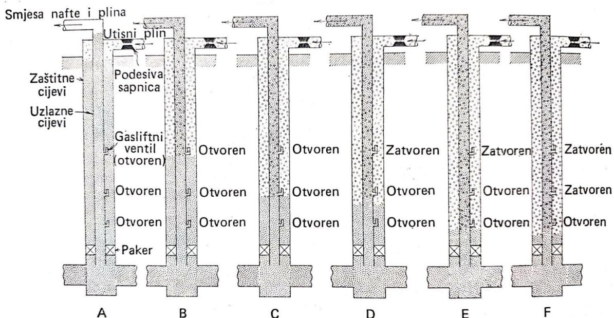
Slika 2-2. Postupak rasterećenja neprekidnog plinskog uređaja (Zelić, 1977)
