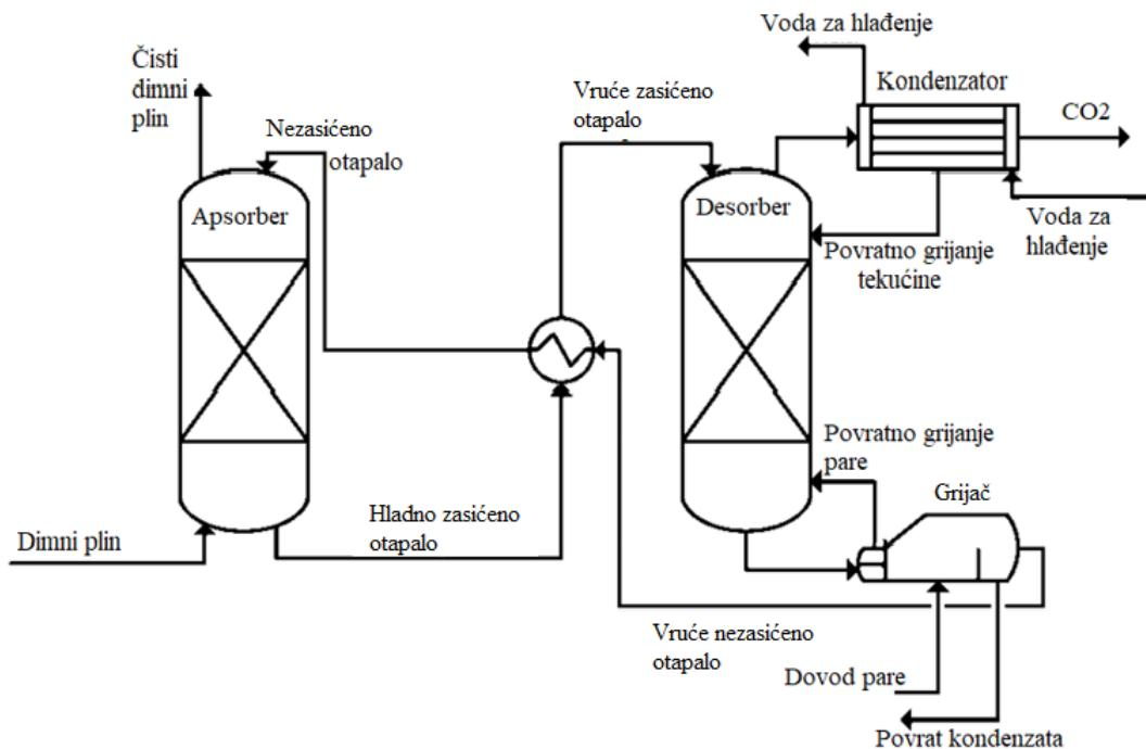
**Slika 3-2.** Postupak hvatanja CO<sub>2</sub> kemijskom apsorpcijom (MacDowell et al., 2010)
